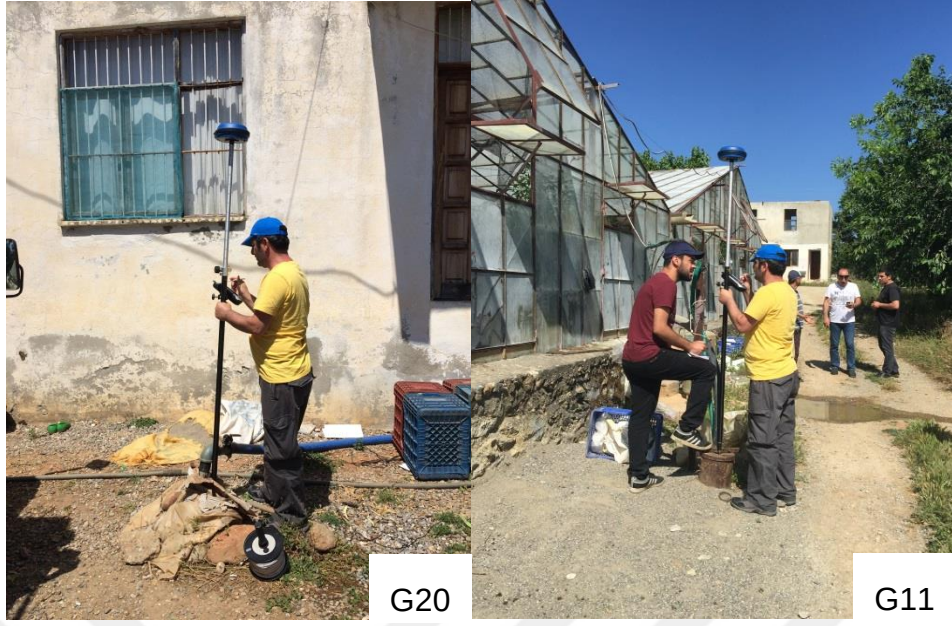
Şekil 3.1. Ölçüm ve örnekleme yapılacak su noktası koordinatlarının belirlenmesi.
