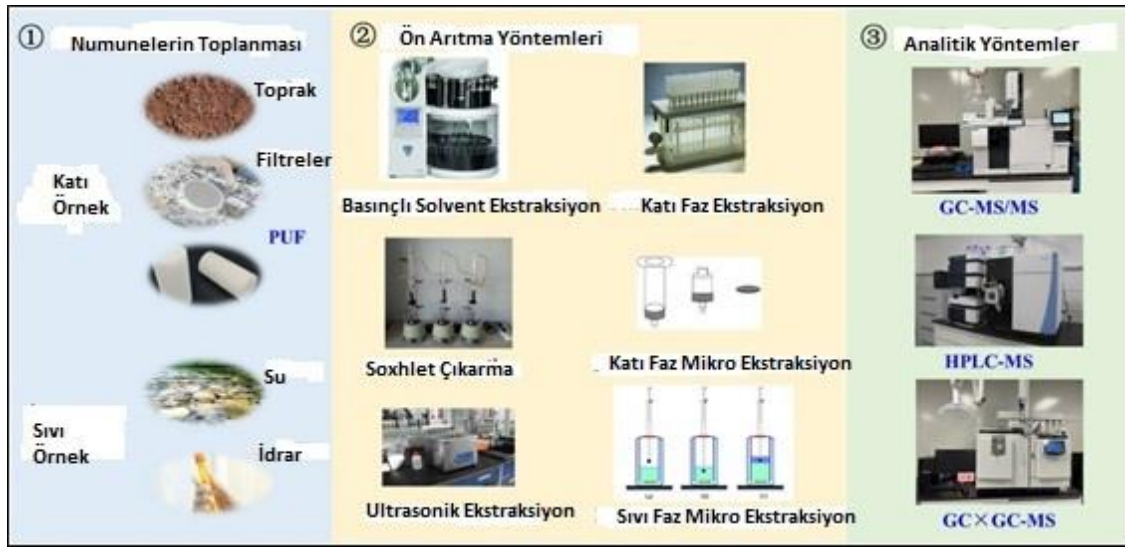
Şekil 2.3 Sulu ve katı numunelerdeki PAH oluşumunda matris cinsi, saflaştırma, ekstraksiyon teknikleri ve kullanılan cihazlara dair gösterim.
