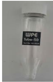
Şekil 3.1 WPE-Tube-50V2 katı faz mikro ekstraksiyon tüpü.
