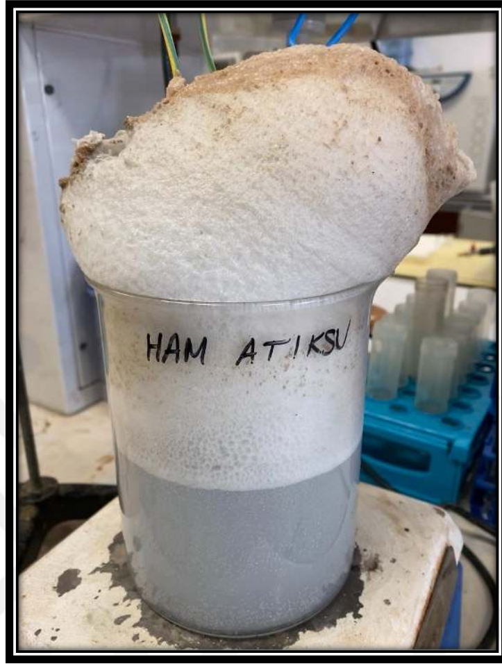
Görsel 5.2. Aşırı Isı ve Voltaj Yükselmesi Sebebiyle Deney Sonunda Kabaran Numune
