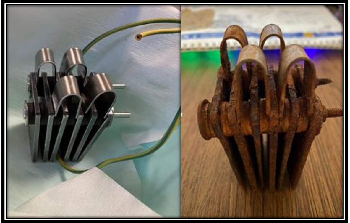
Görsel 7.4. Deneysel Çalışmalardan Öncesi ve Sonrası Demir Elektrot Kümesi
