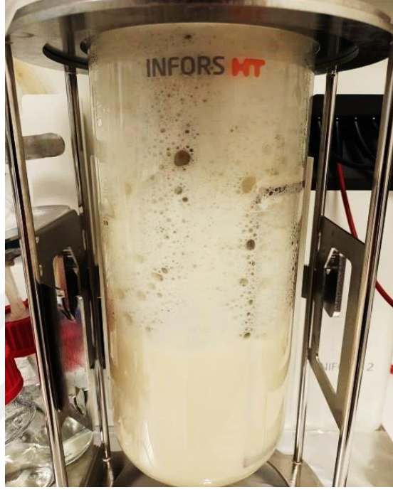
Fotoğraf 4.4. Fermentör ortamında Cyb. fabianii MİAU-1 suşu ile biyosürfektan üretiminde fermantasyon sonuna (48 saat) ait örnek bir görüntü
