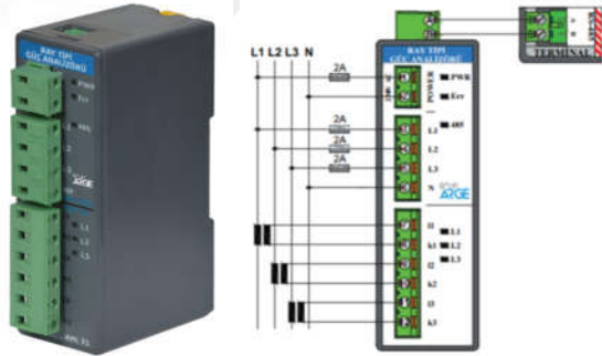
Şekil 3. 2. Projede kullanılan GA4131 ray tipi güç analizörü
