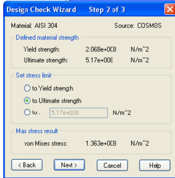
Şekil 6.1.13 Maksimum Von Mises gerilmesi sınır kriterleri
