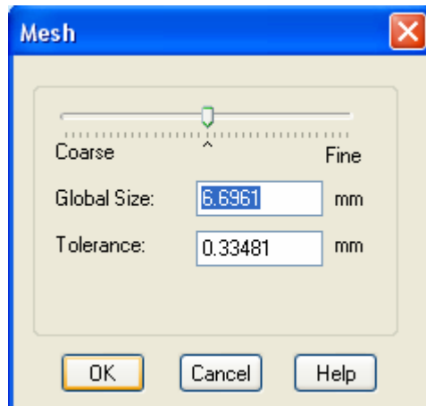
Şekil 6.3.6 Parçaya uygulanan mesh hassasiyeti
