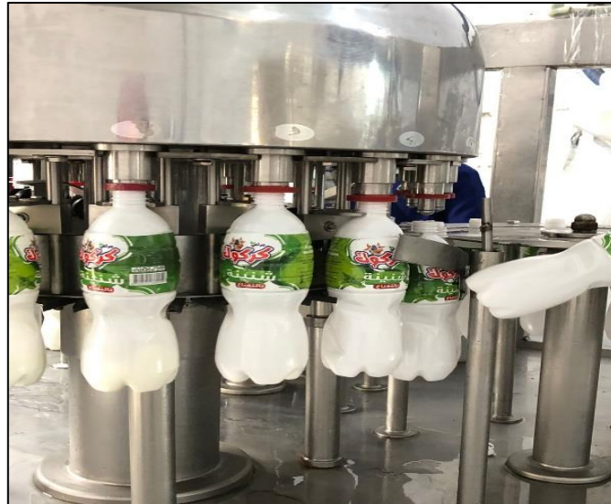
Görsel 3.8. Şişelerin dolum cihazında doldurma işlemi
