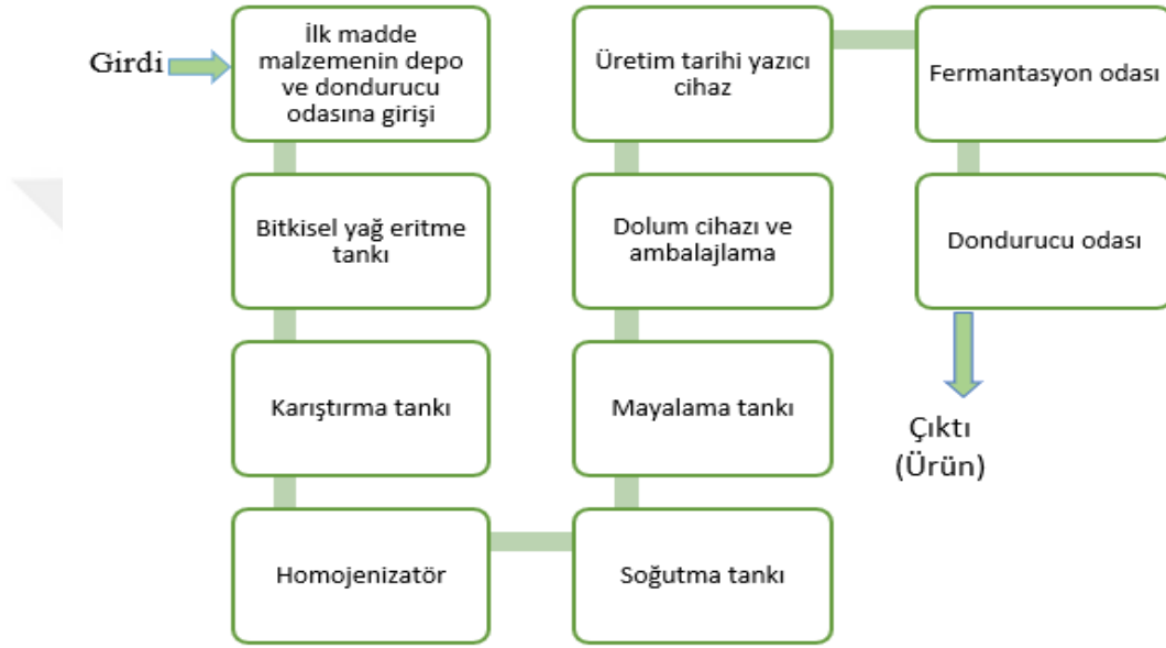
Şekil 3.1. Ayran üretimi akış şeması
