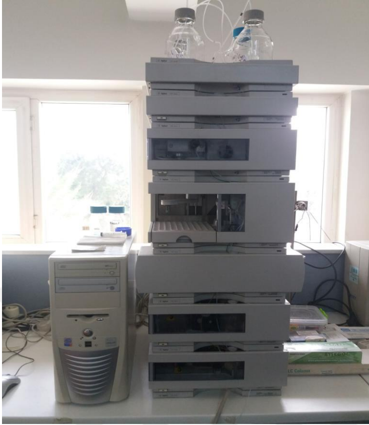
Şekil 3.2. Çalışmalarda kullanılan Agilent marka 1100 model HPLC cihazı
