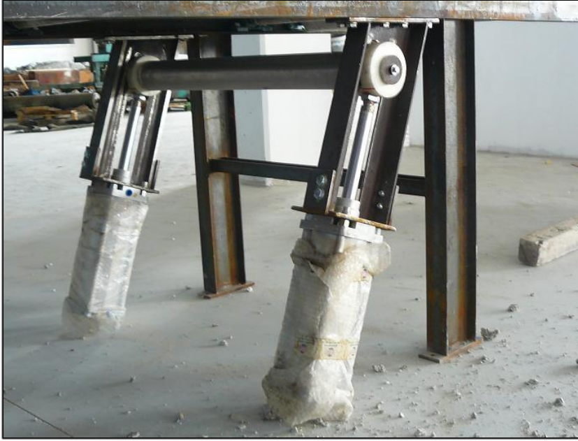
Şekil 3.14. Pnömatik gergi tertibatı montajı
