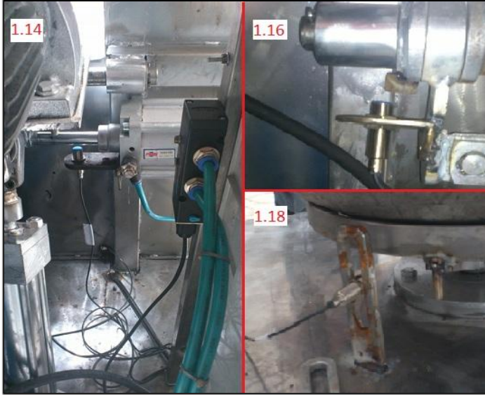
Şekil 3.3. Karıştırma nokta sensörü (1.14), karıştırma küreği yükseklik seviye sensörü (1.16), karışım haznesi pozisyon sensörü (1.18).
