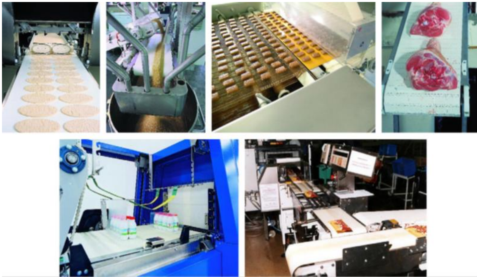
Şekil 2.2. Sentetik bantlı konveyör sistemleri [29]
