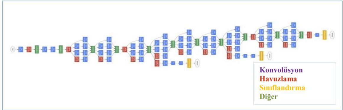
Şekil 4.11. GoogLeNet ağ mimarisi (Kaynak: İnik vd., 2017)
