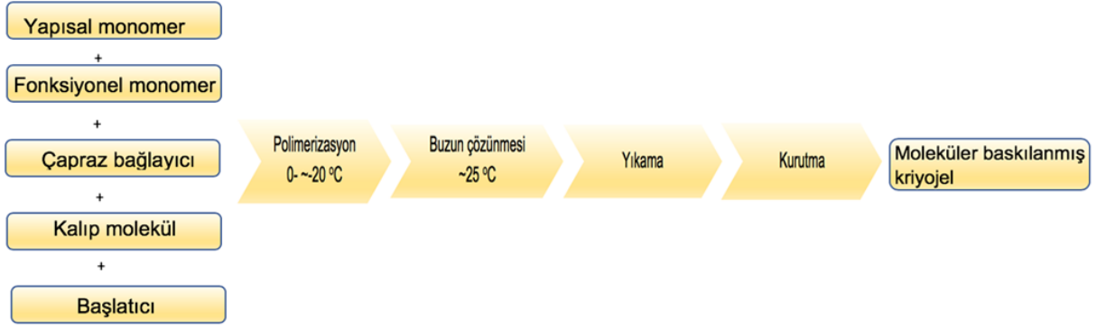
Şekil 2.10. Moleküler baskılanmış kriyojellerin hazırlanmasının şematik gösterimi.
