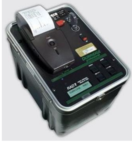
Şekil 3.22. RAD-7 radon detektörü (Durrige Company,1997).
