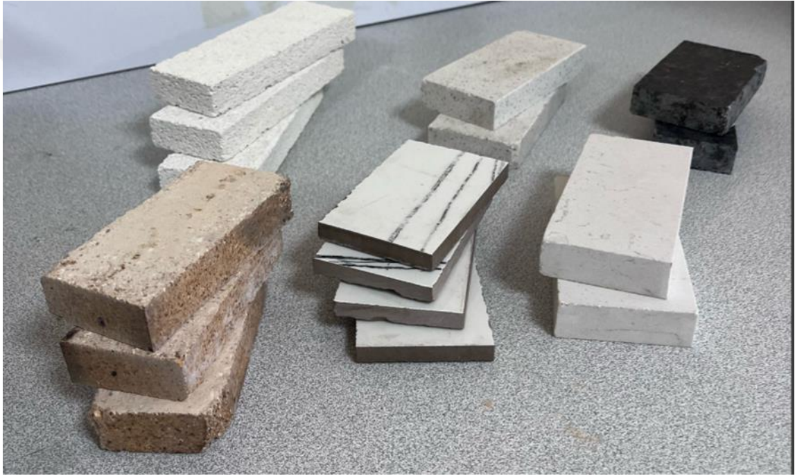
Şekil.3.11. Farklı Kalınlıkta bazı yapı malzemesi örnekleri (Ateş Tuğla, İzolasyon Tuğla, Granit1, Granit2, Granit3, Seramik)
