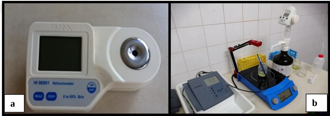
Şekil 3.12. Çalışmada kullanılan dijital refraktometre (a) ve titrasyon işleminden bir görünüm (b)
