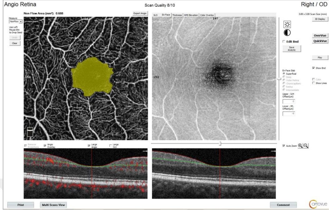
Şekil 13. Yüzeyel kapiller pleksusta en face ve B-scan görüntüleri ile akım olmayan alanın ölçümü (mm 2 ) (sarı renkli alan)
