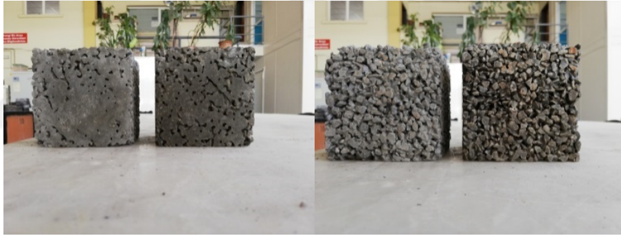
Şekil 4.4 a) Çimento pastasının tabana çökerek numunelerin tabanını tıkaması b) Tabanı tıkalı numunelerin yandan görünüşü (Kişisel arşiv, 2019)
