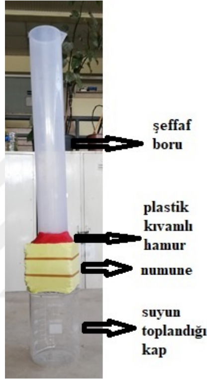
Şekil 4.8 Geçirimlilik deneyi düzeneği (Kişisel arşiv, 2019)
