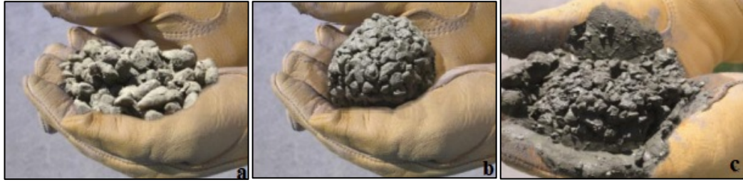
Şekil 2.1 Farklı su içeriklerine sahip taze halde geçirimli beton örnekleri (top haline getirilmiş) a) az su içeriği b) yeter miktarda su içeriği c) fazla miktarda su içeriği (Tennis ve diğer., 2004)
