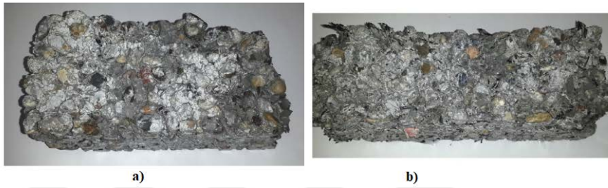
Şekil 2.15 300 donma çözülme döngüsü sonucu numunelerin görünüşü a) kontrol numunesi b) atık lastik kullanılmış numune (Gesoğlu ve diğer., 2014b)
