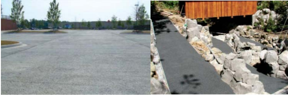
Şekil 1.7 Geçirimli betonun otopark alanında ve yaya kaldırımında kullanımı (Tennis ve diğer., 2004)
