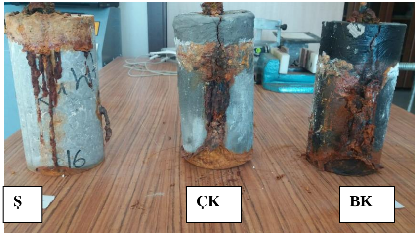
Resim 5.3 Şahit, çimento esaslı ve bitüm esaslı numunelerin korozyon hasarları.
