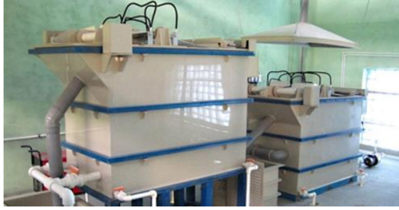
Şekil 3.8. Elektroflotasyon prototip sistemin düzeneği.
