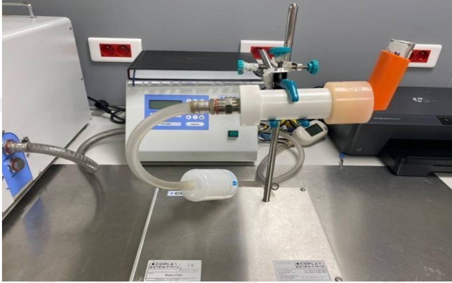
Şekil 2.5: Ölçülü Doz Aerosol'ün Ortalama Doz Ağırlığı Analizi
