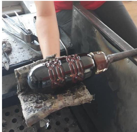
Görsel 5. 10. Üfleme piposuna alınmış graal çekirdeğinin ısı ile yumuşatılması (Kaynak: Ecem Küpeli fotoğraf arşivi)
