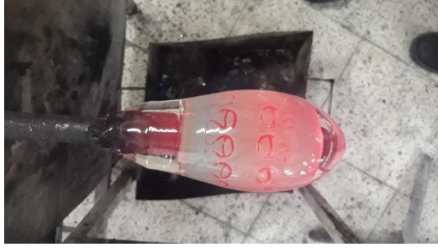
Görsel 5. 15. Kazınmış olan graal çekirdeğinin şekillendirme aşaması (Kaynak: Ecem Küpeli fotoğraf arşivi)
