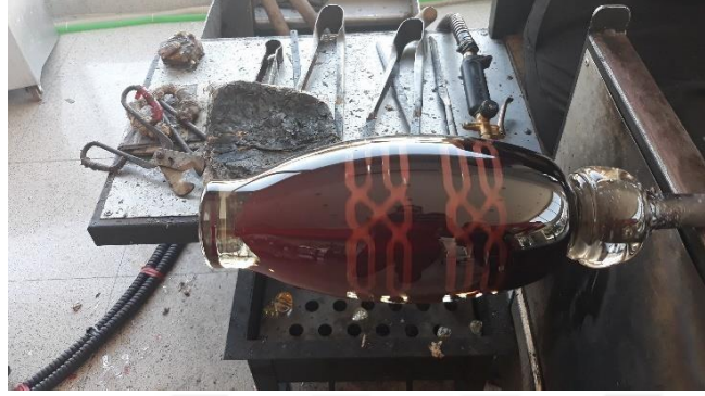
Görsel 5. 11. Graal çekirdeği üzerine alınmış camın şekillendirilmesi (Kaynak: Ecem Küpeli fotoğraf arşivi)
