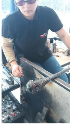
Görsel 5. 8. Graal çekirdeğinin üfleme piposuna alınarak kenarlarının yumuşatılma aşaması (Kaynak: Ecem Küpeli fotoğraf arşivi)
