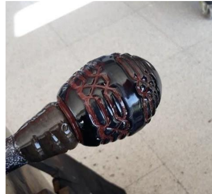
Görsel 5. 8. Graal çekirdeğinin üfleme piposuna alınarak kenarlarının yumuşatılma aşaması (Kaynak: Ecem Küpeli fotoğraf arşivi)
