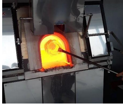
Görsel 5. 3. Sıcak cam fırını içerisinde bir katman daha cam alınma süreci (Kaynak: Ecem Küpeli fotoğraf arşivi)
