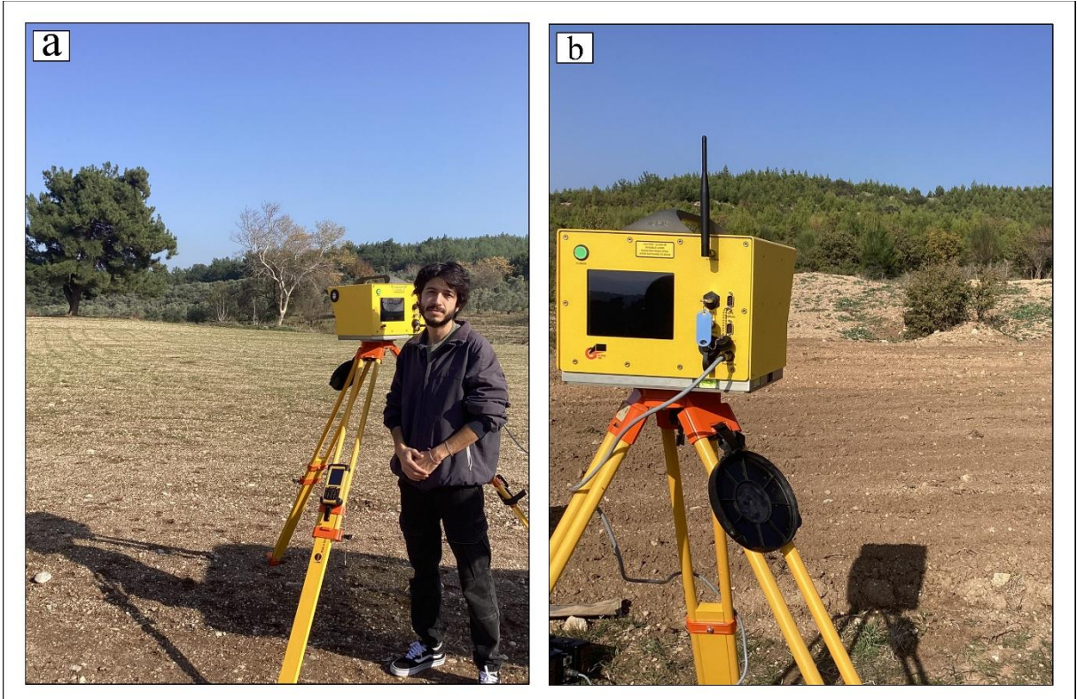
Şekil 2.3. Karaca ağaç Hendeği Lidar ile Mikrotopografya Haritası Üretme Aşaması
