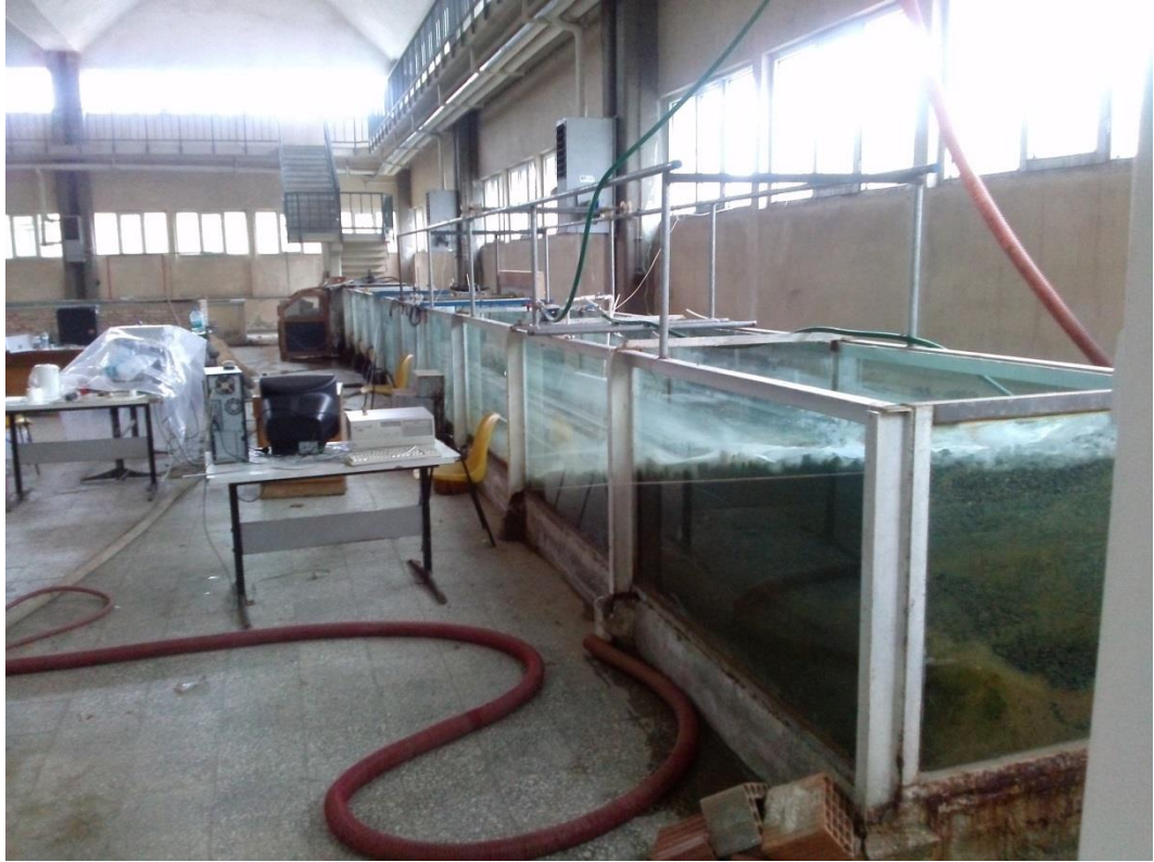
Şekil 4.1 : Düzensiz dalga üretici kanal
