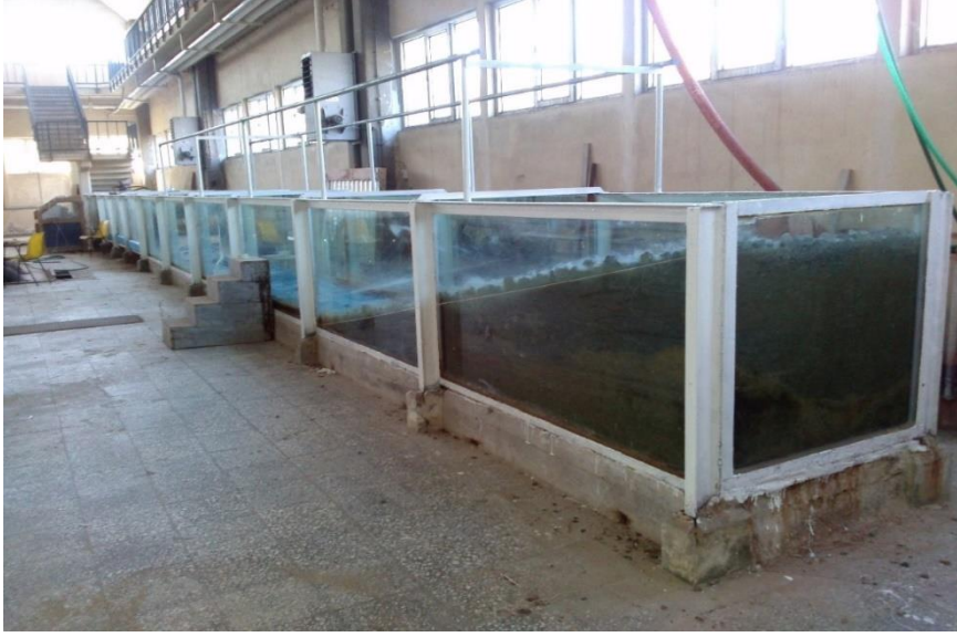
Şekil 1.1 : Düzensiz dalga üretici kanal
