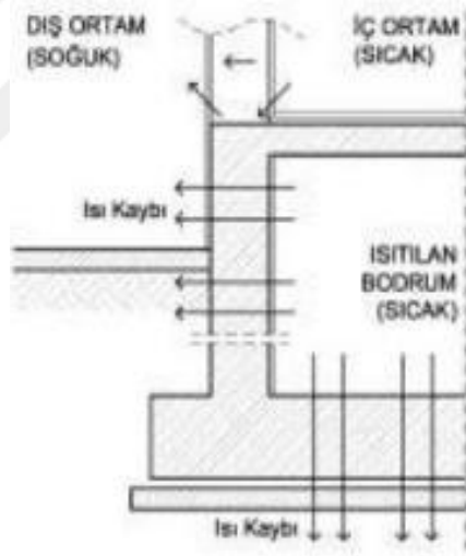
Şekil 5.10 Isıtılan Bodrum Duvarı ve Döşemesinde Isı Kaybı
