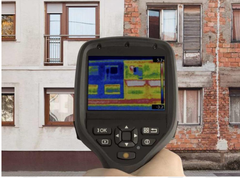
Şekil 2.11 Termal Kamera Cihazı
