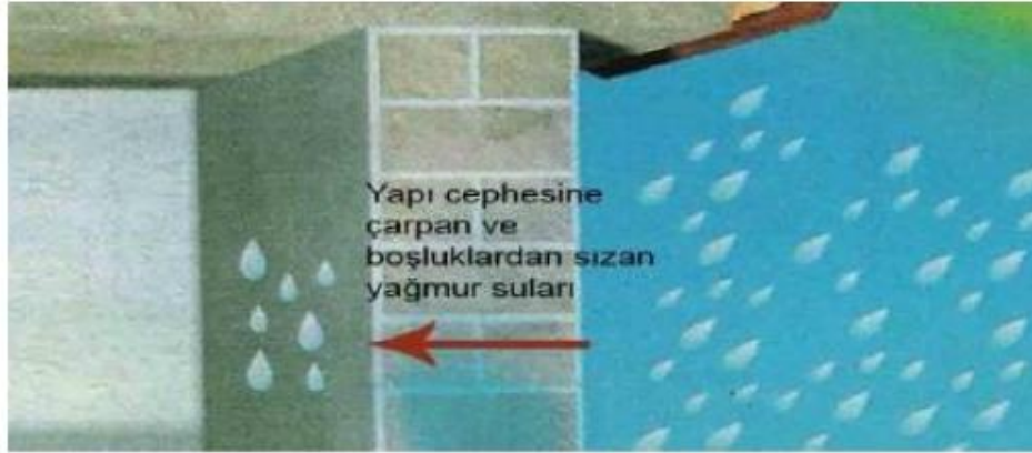
Şekil 5.18 Yağışların Yapı Cephesinde Etkisi
