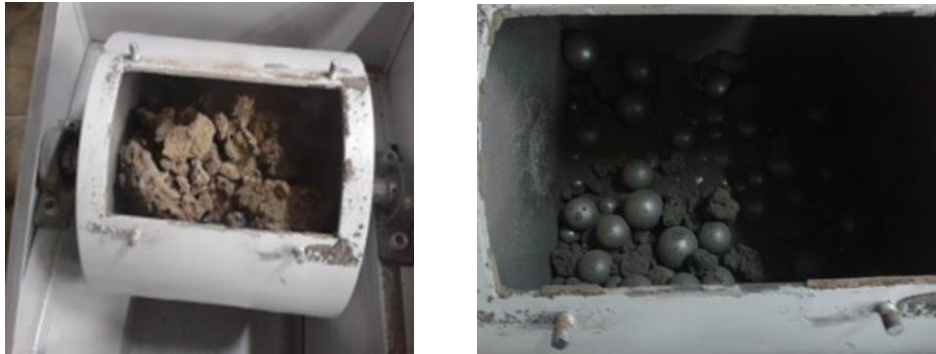
Şekil 9: Bilyalı değirmende kömür cürufunun öğütülmesinden görünüm.
