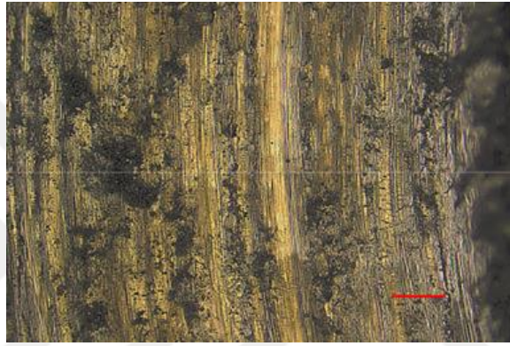
Şekil 40: 3 Newton yük altında meydana gelen aşınmalara ait profil görünümü.
