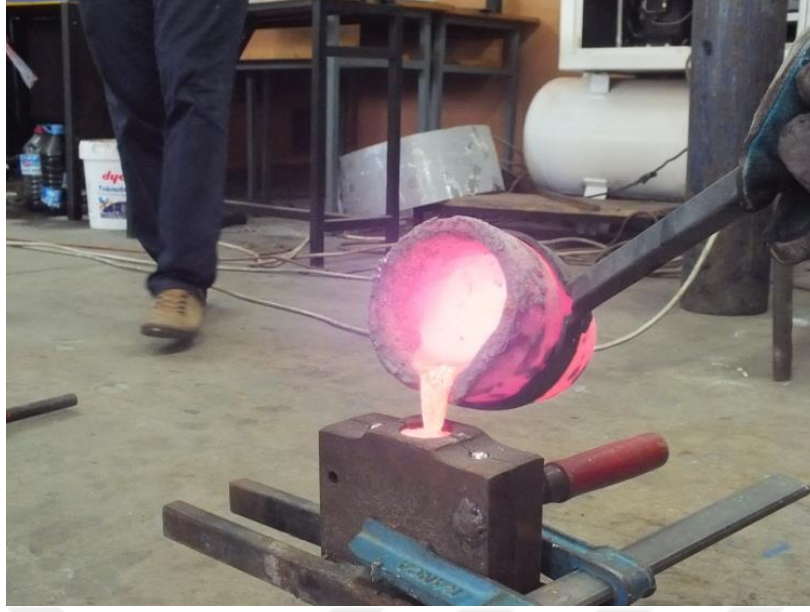
Şekil 20: Hibrit kompozitin kalıba dökülmesinden görünüm.
