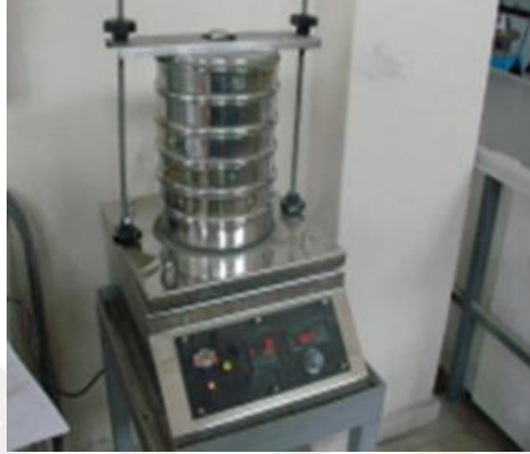
Şekil 10: Kömür cürufunun elekte elenmesinden görünüm.
