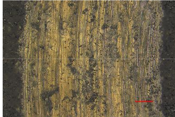
Şekil 39: 1 Newton yük altında meydana gelen aşınmalara ait profil görünümü.
