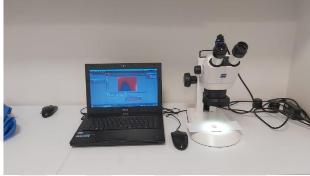
Şekil 3. 12. Silikon replikanın stereomikroskop altında incelenmesi
