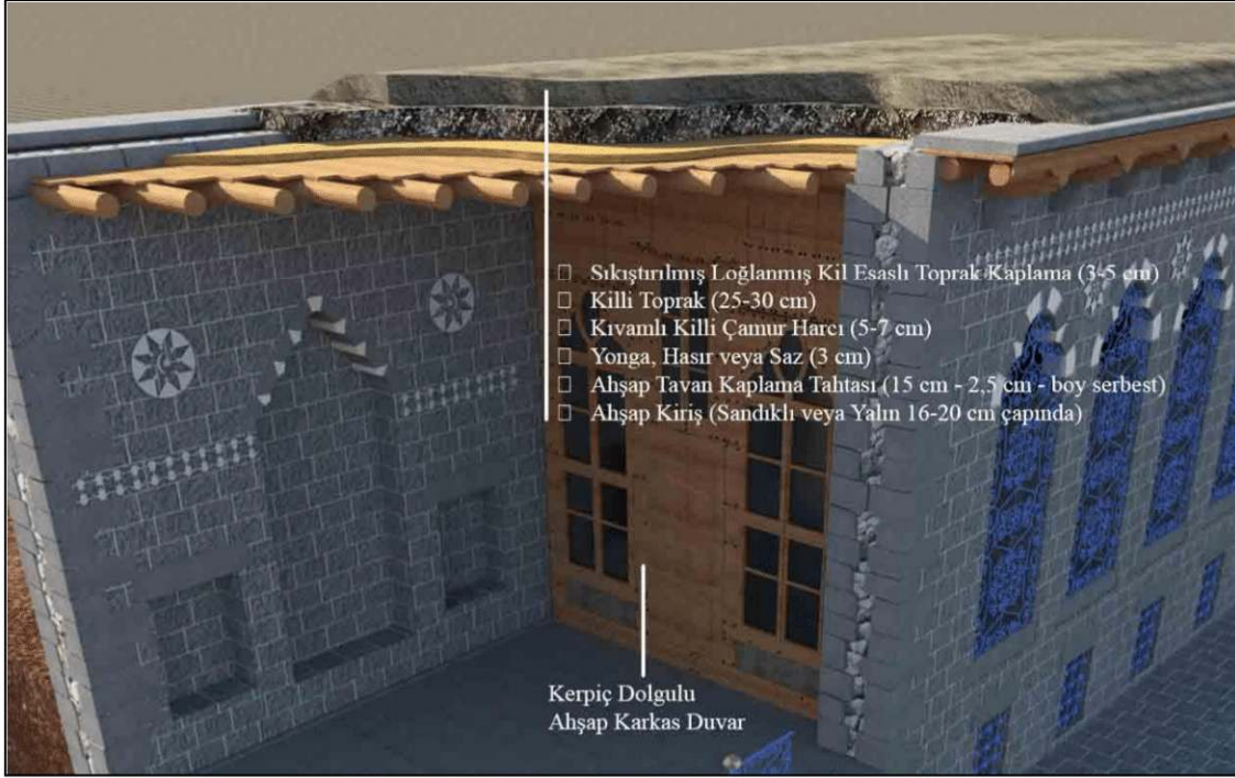
Şekil 4.97. Dam örtüsü katmanları, üç boyutlu görsel modeli
