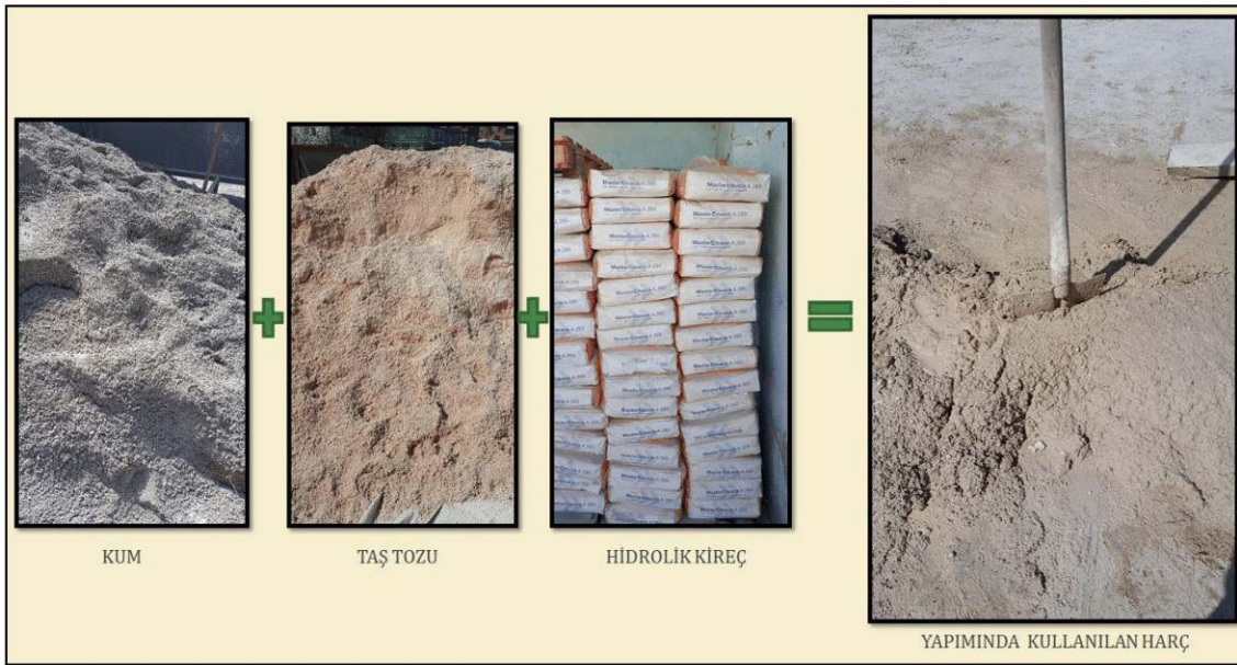
Şekil 5.9. Günümüz restorasyonlarında sıklıkla kullanılan harç karışımı
