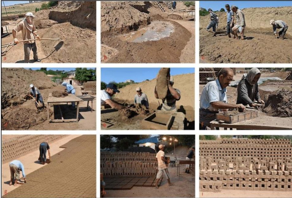
Şekil 4.37. Harman tuğlası hazırlanması, şekillenmesi ve kurutulması
