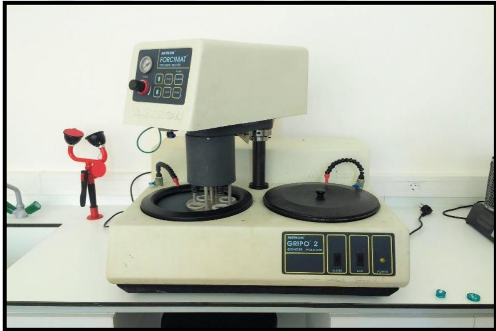
Fotoğraf 3.7. Örneklerin taşlama ve parlatma makinası işlemi.
