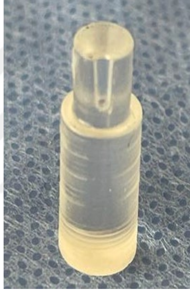
Şekil 3.5. Epoksi rezinden hazırlanan güdükler
