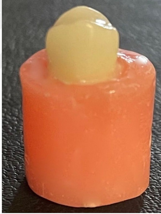
Şekil 3.16. Epoksi rezin güdüklerin otopolimerizan akrilik rezin ile desteklenmesi
