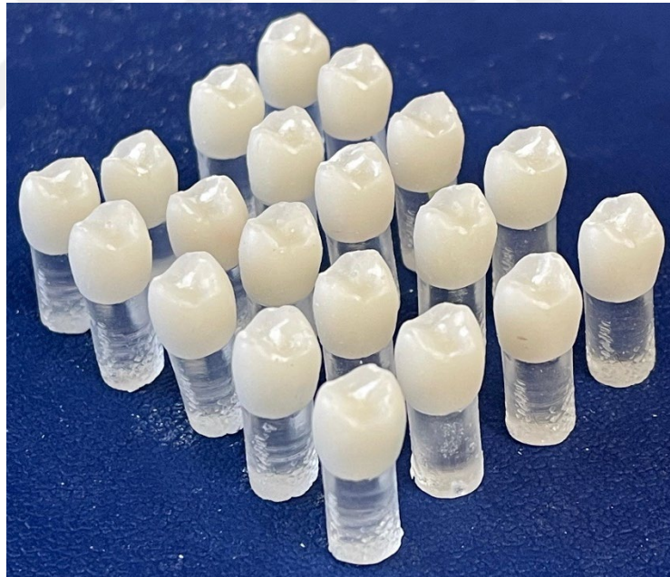
Şekil 3.11. Eklemeli yöntemle hazırlanan sabit geçici restorasyonlar
