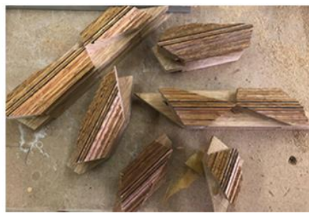
Şekil 5.1. Künde-kârı kapı göbeği iç dolgu parçaları (a) ve omurga çıtaları (b) (Gülizar Büşra Kılıç).
