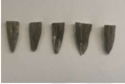
Resim 3.5. SEM görüntülemesi için altın-paladyum ile kaplanan örnekler
