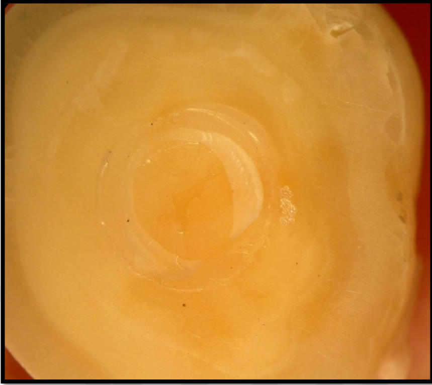
Resim 8: Koheziv rezin kırık
