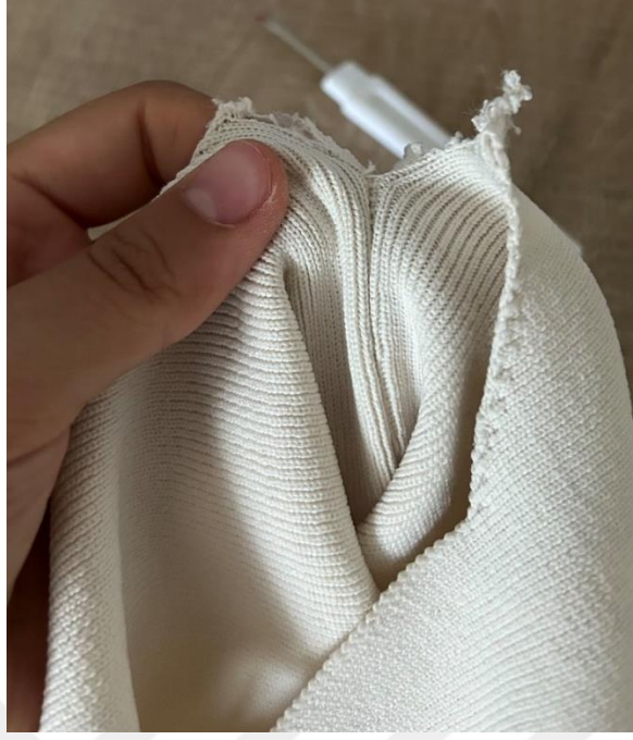
Şekil 244. Bluzun Yanlarının Sökülmesi
