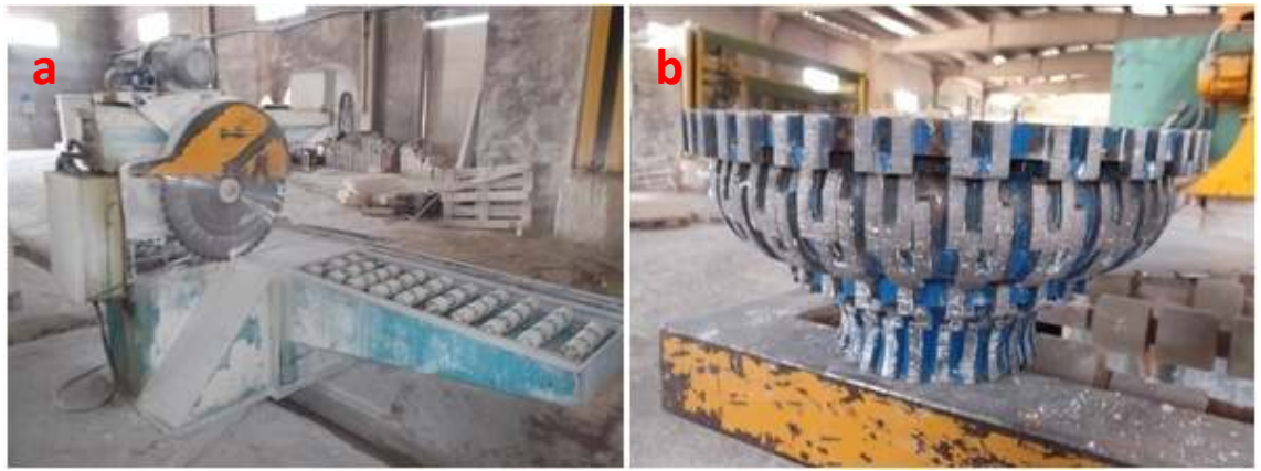
Şekil 7.59. Profil – Yan kesim makinesi (a) ve alınlık, kornej yapmada kullanılan aparat (b)
