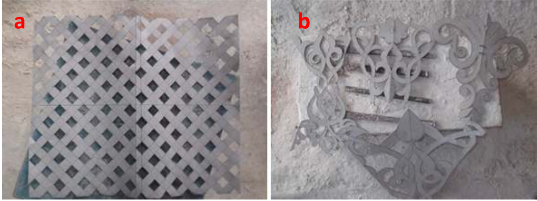
Şekil 7.65. Taş yontucuların kullandıkları şablonlar
