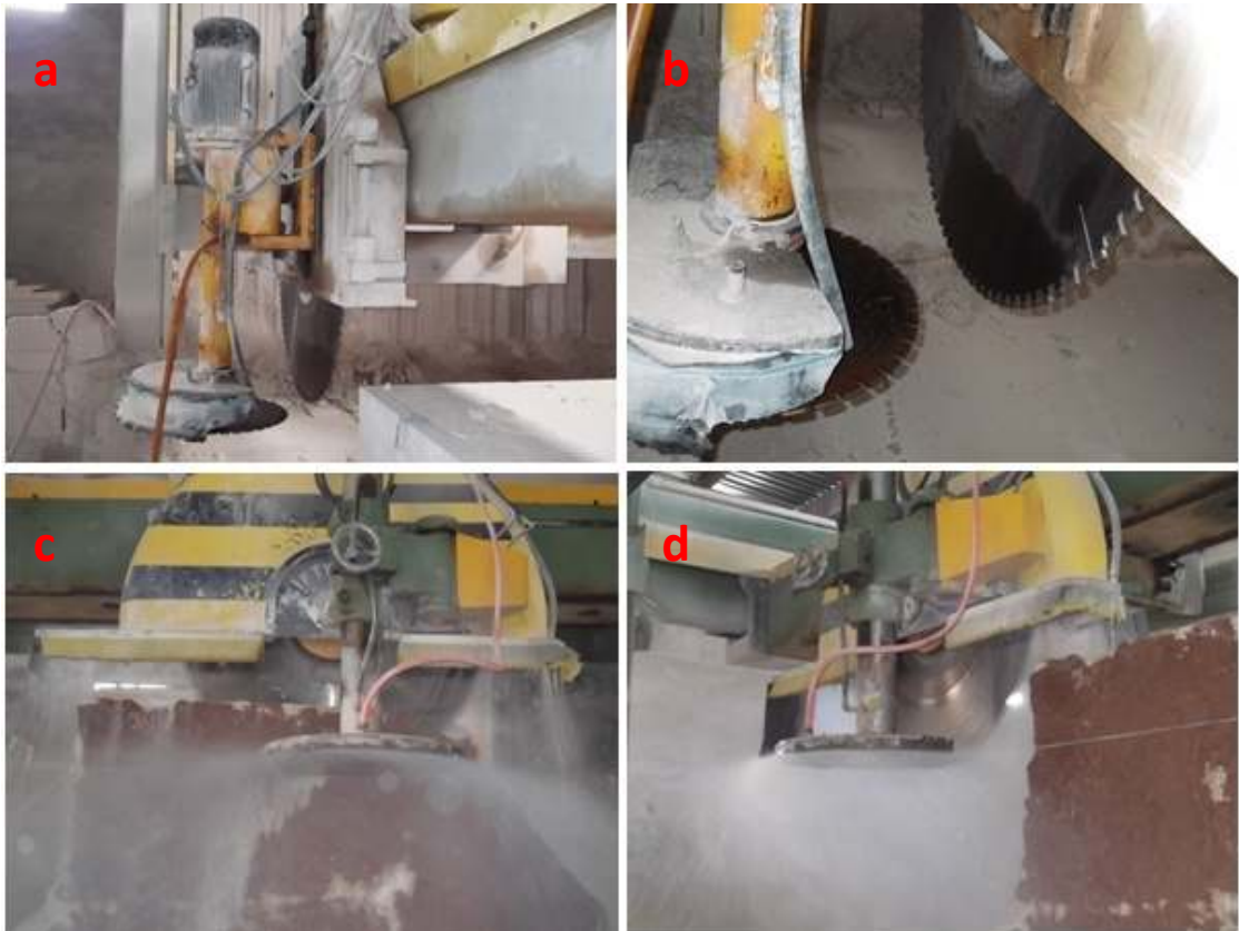
Şekil 7.54. Büyük Este Makinesinin düşey ve yatay kesimler yapan testereleri
