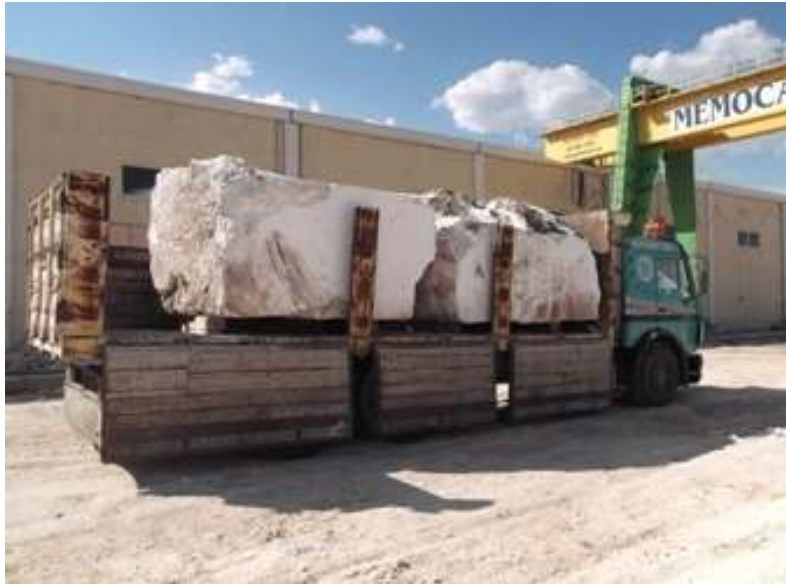
Şekil 7.51. 30 tonluk vinç ve araçla getirilen yaklaşık 15 tonluk blok taşlar
