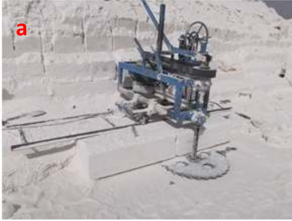
Şekil 7.33. Taş yatay (alttan) kesme makinesi
