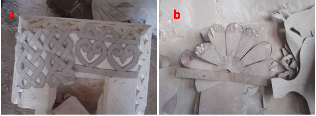
Şekil 7.64. Taş yontucuların kullandıkları şablonlar
