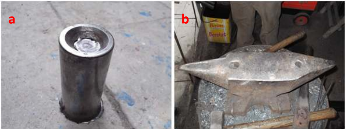
Şekil 5.22. Çivi başlık kalıbı (a) ve demir dövme yeri (hörs) (b)
