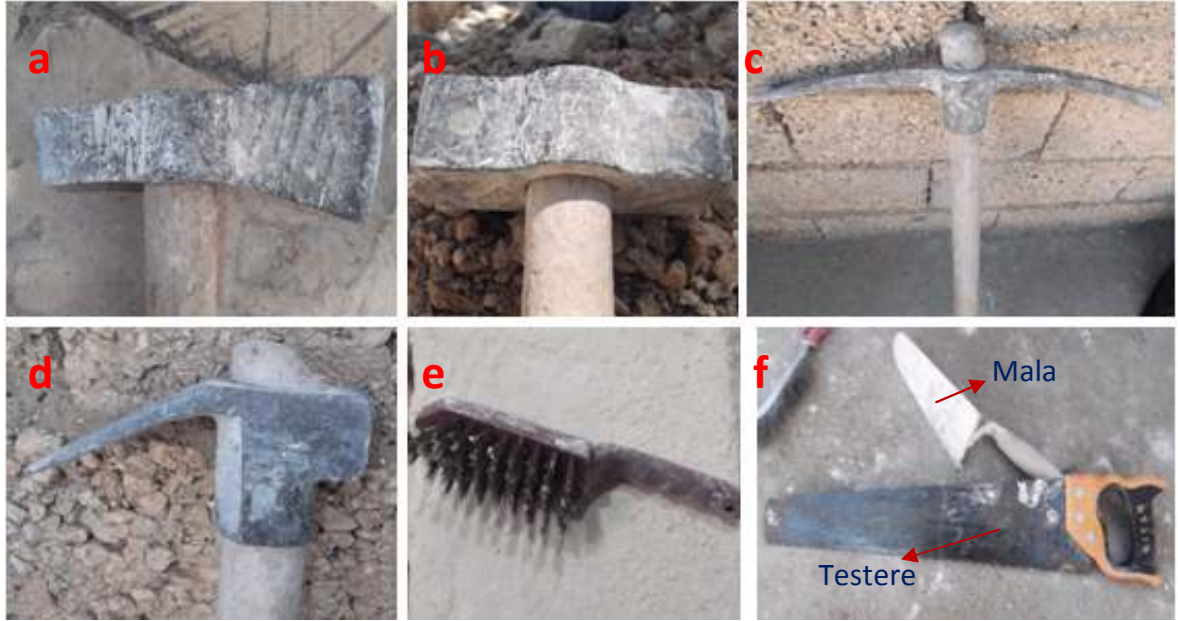
Şekil 6.67. Çekiç (a), balyoz (b), kazma (c), keser (d), derz fırçası (e), testere ve mala (f)
