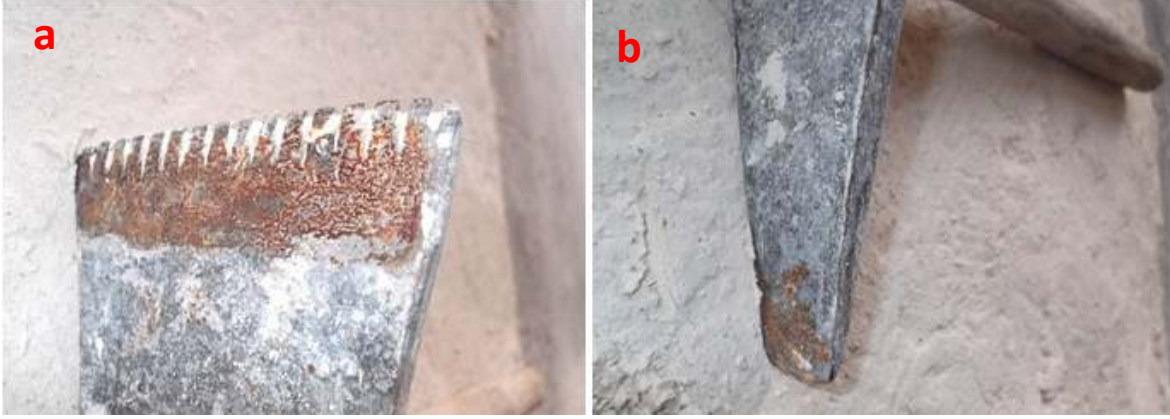
Şekil 6.47. Tarak; dişli (a) ve düz kısım (şevk) (b)
