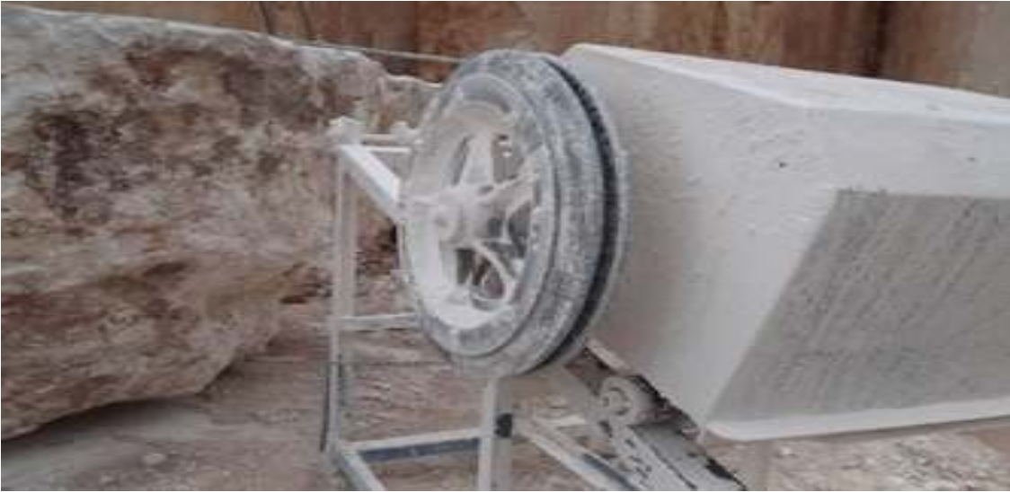
Şekil 7.26. Seyyarlama makinesinin halatının blok taşın kesilecek kısmına sarılması
