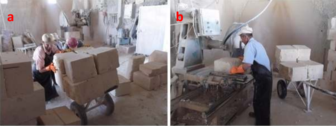
Şekil 7.62. Taşların atölye içine kesim makinelerine taşınması
