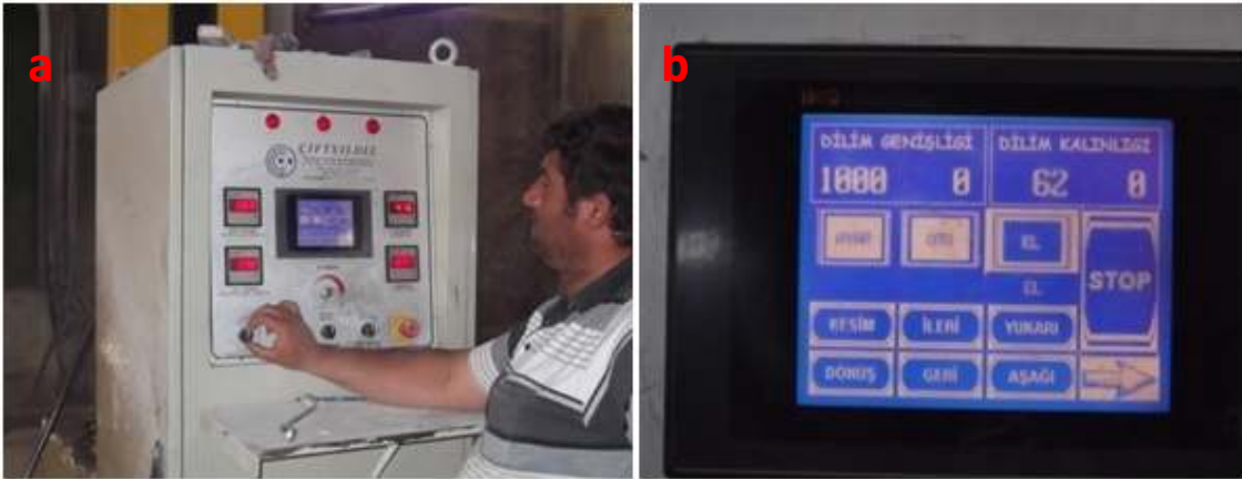
Şekil 7.57. Büyük Este Makinesinin testere hızlarını ve kesimi yapılacak taşın kalınlık (yükseklik), genişlik ölçülerini ayarlayan pano
