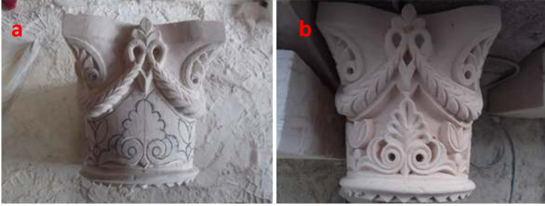
Şekil 7.67. Taş yüzeyine şablonla desen çizimi (a) ve taşın işlenmiş hali (b)
