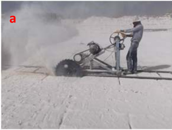
Şekil 7.34. Taş kesme işlemi
