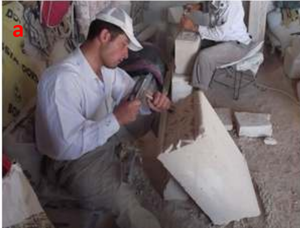
Şekil 6.53. Nakkaşın taş yüzeyine şablonla çizilmiş deseni çıkarması
