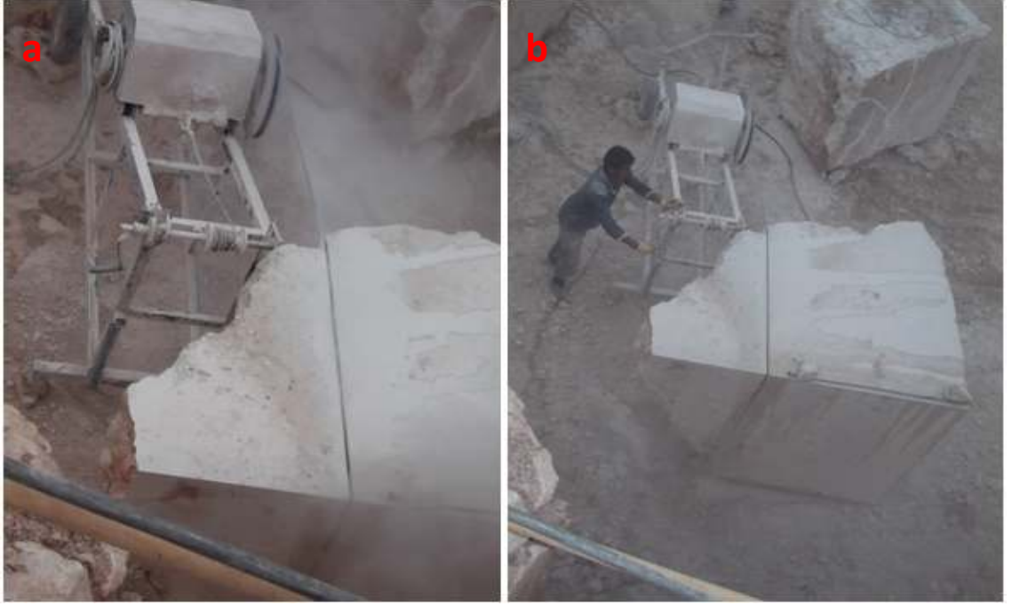
Şekil 7.28. Blok taştan eğri parçanın elmas uçlu halatla kesimin gerçekleşmesi
