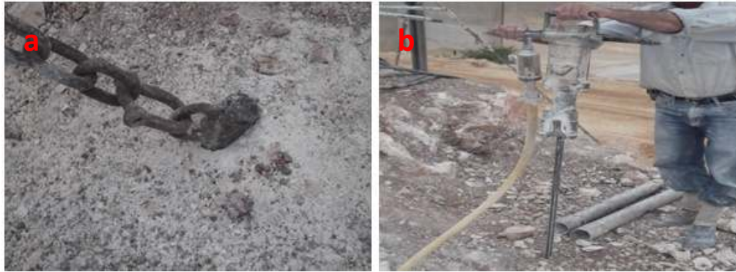
Şekil 7.21. Delici makinasını kayaya üç noktadan sabitleyen zincir (a), Matkap (zincirleri sabitlemede kullanılan delikleri açar) (b)
