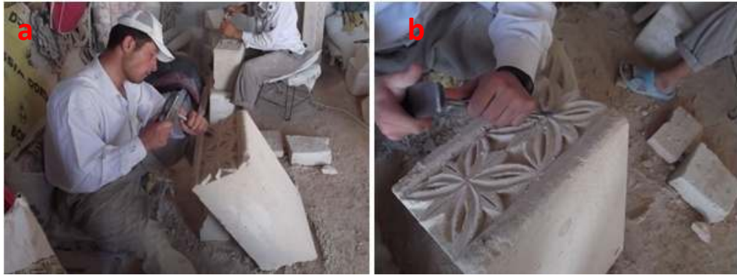
Şekil 7.66. Taş yontucuların, taş üzerine desen çıkarımı
