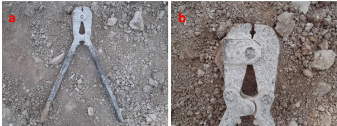
Şekil 7.18. Çelik halat aparatlarını sıkma aleti
