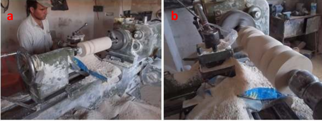
Şekil 7.61. Torna makinesinde taş korkuluk yapımı ve taşın silindir-sütun haline getirilmesi
