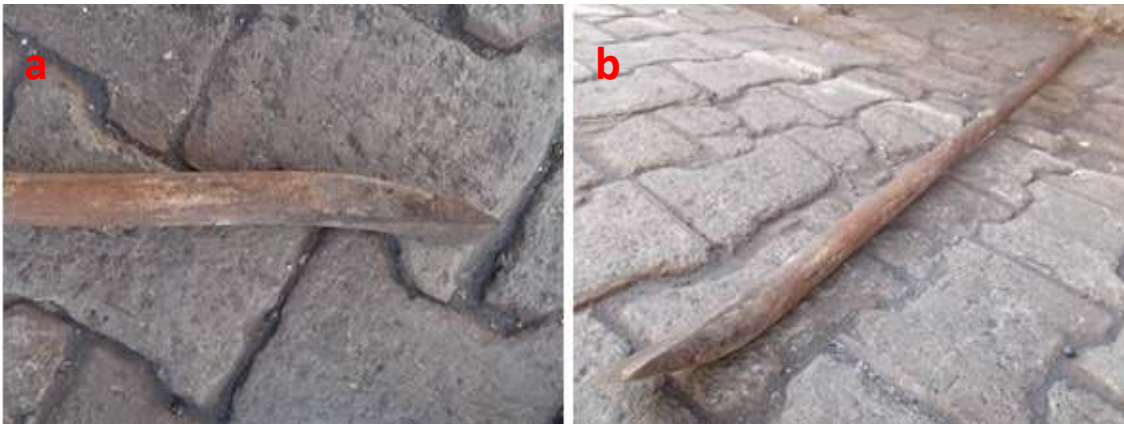
Şekil 6.66. Levye kavisli ağız kısmı ve genel görünümü
