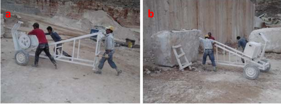
Şekil 7.25. Seyyarlama makinesinin blok taşın kesilecek kısmına taşınması
