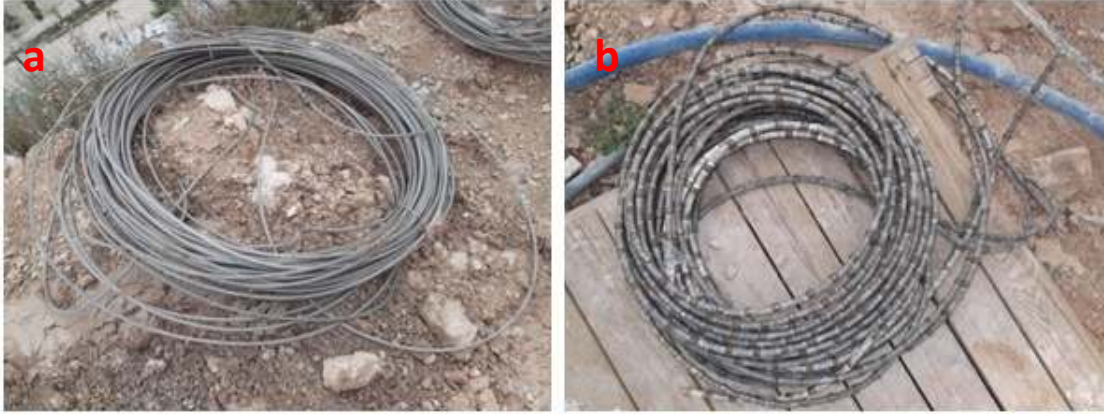
Şekil 7.15. Çelik halat (a) ve aparatlı hali (b)
