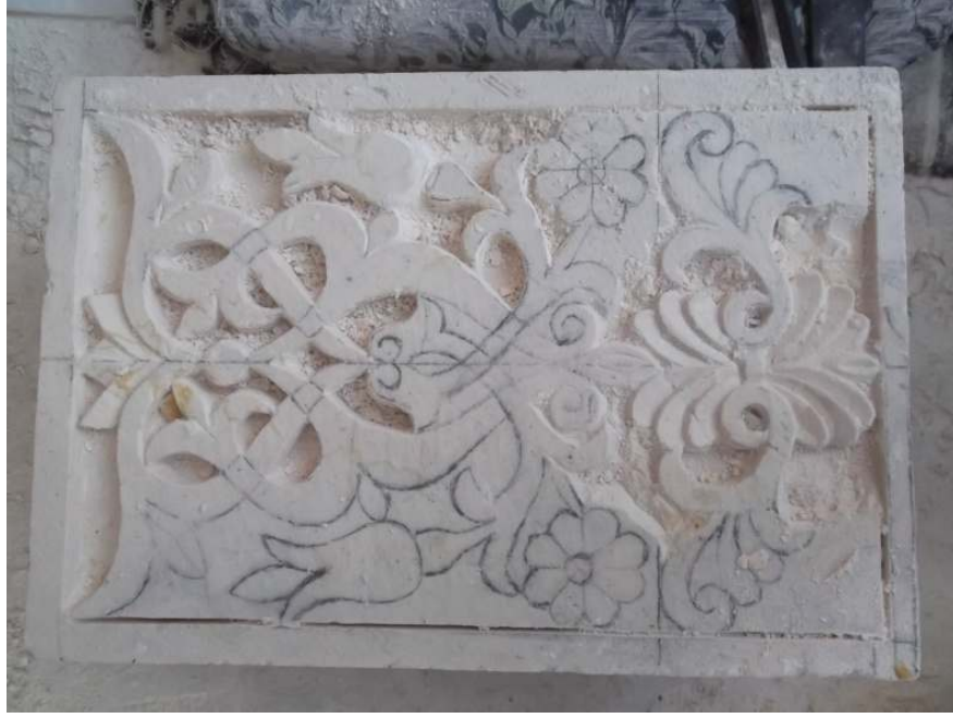
Şekil 6.52. Taş yüzeyine şablon ile çizilmiş ve kısmen oyulmuş desen
