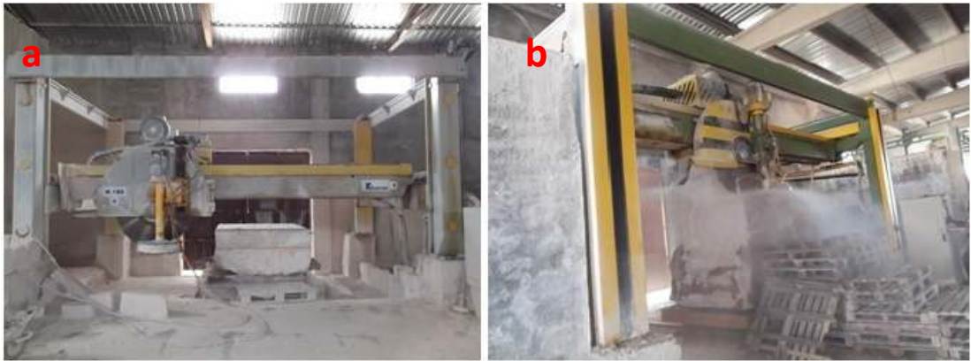
Şekil 7.53. Büyük Este Makinesi (5 x 8 x 6 m boyutlarındadır)
