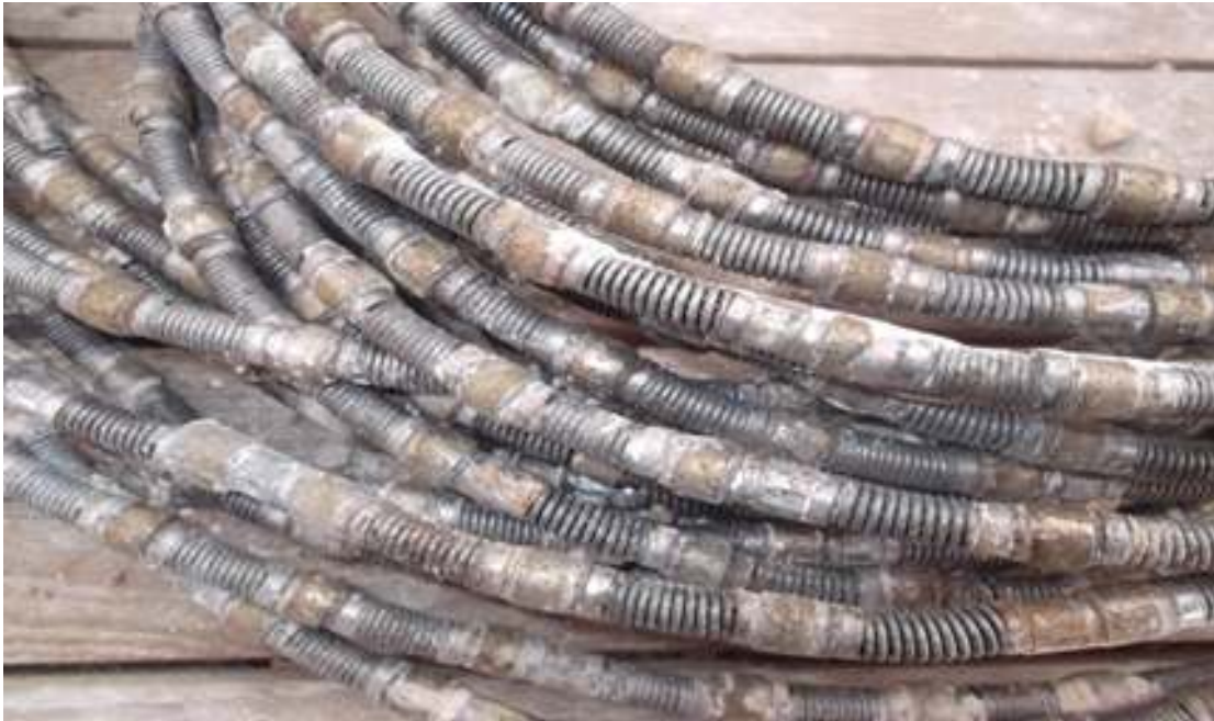
Şekil 7.16. Çelik halat ve aparatları (elmas pul, somun ve yay)
