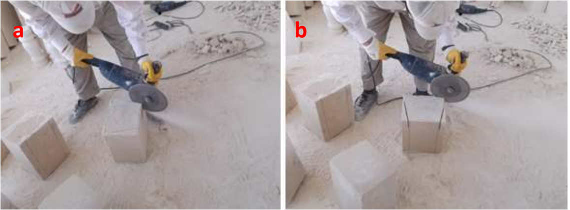
Şekil 6.14. Spiral makine ile taşa çizilen kalıbın çıkarılması
