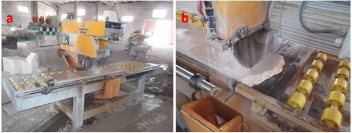
Şekil 7.58. Baş Kesme Makinesi (4 x 70 m boyutunda)
