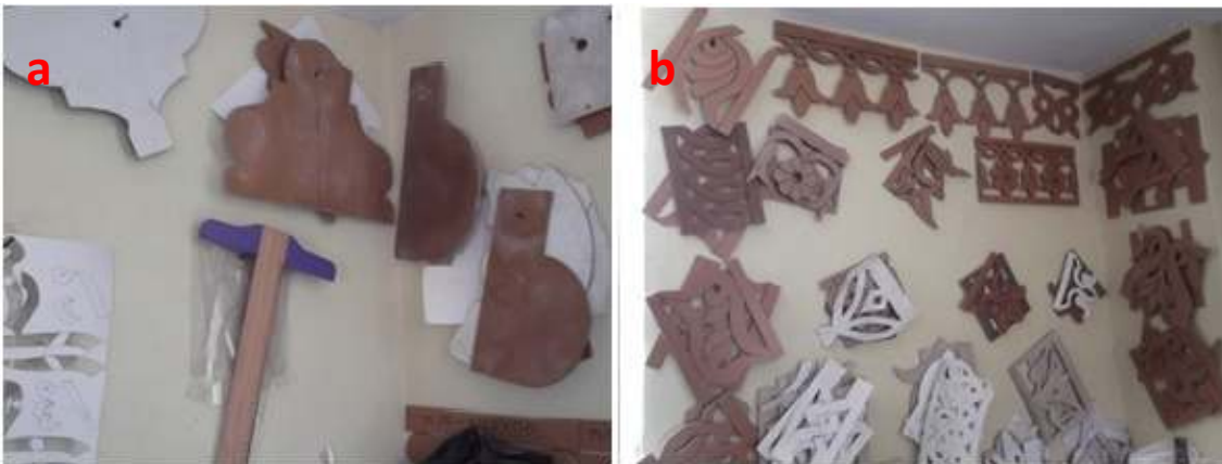
Şekil 6.51. Karton kâğıt ve sunta tahtadan yapılmış şablonlar
