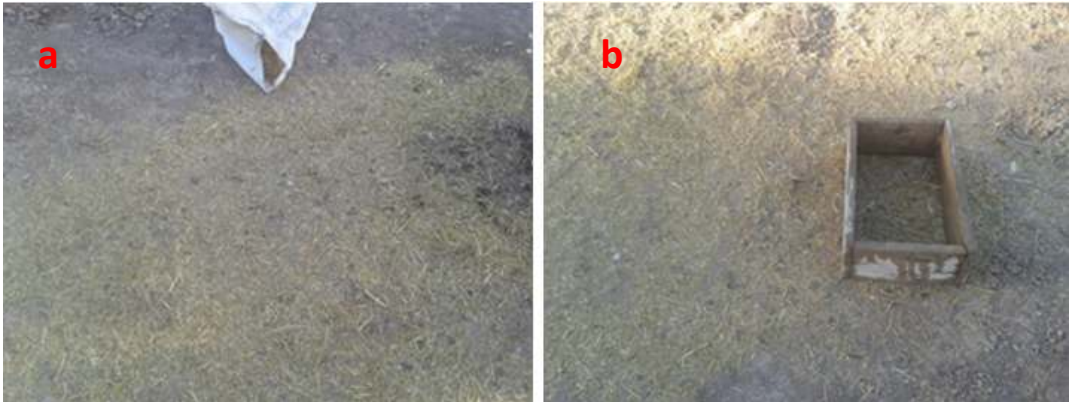
Şekil 5.5. Kalıplanacak zemine samanın serpiştirilmesi (a) ve kerpiç kalıbın zemine yerleştirilmesi (b)
