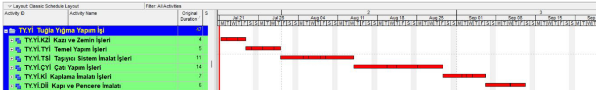
Şekil 38. Tuğla yığma yapı Gant diyagramı
