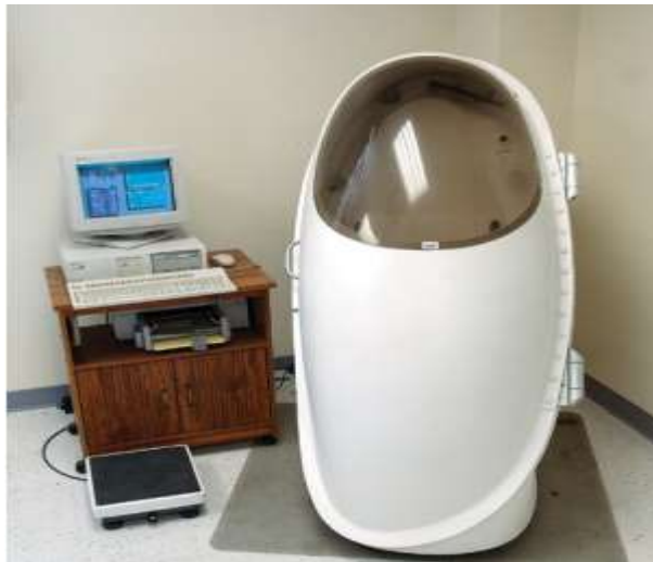
Şekil 2.2.3. ADP'yi gerçekleştiren bir Bod Pod
