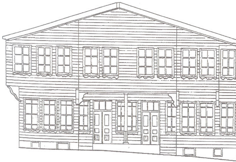
Şekil 2.7 İki tarafa eğimli çatı örneği [Satkın,1996]
