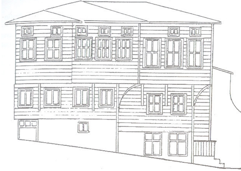
Şekil 2.8 Dört tarafa akıntılı çatı örneği [Satkın,1996]
