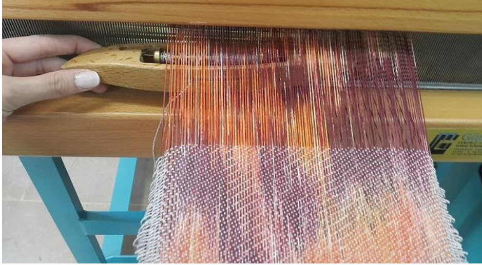
Resim 79: Çözü İplikleri Üzerine Atkı Atma İşlemi
