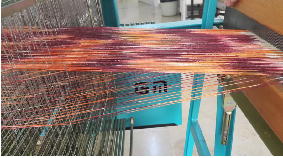
Resim 77: Gücü ve Tarak Tahar İşleminin Yakın Görüntüsü
