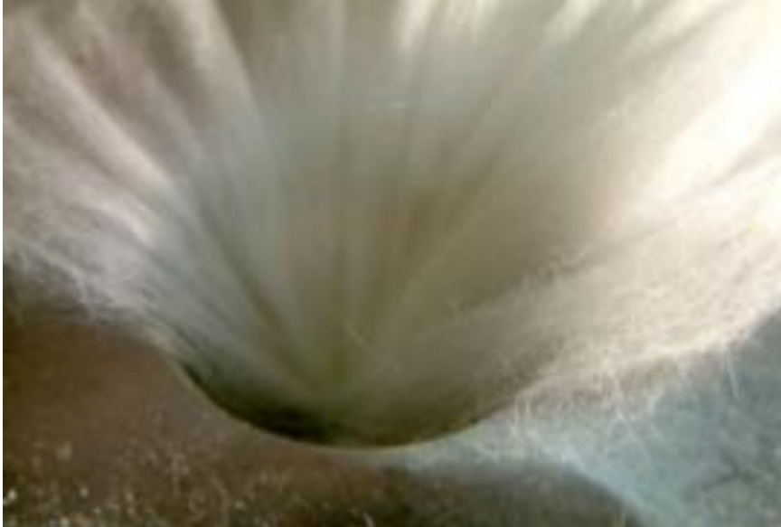
Resim 1: Mikroskop Altında İncelenmesi için Hazırlanmış Pamuk Lifinin Görüntüsü
