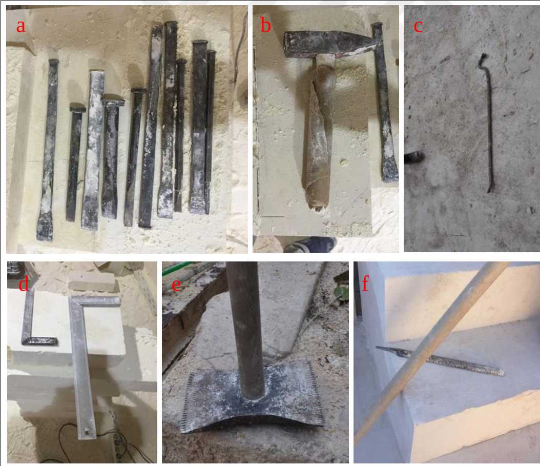
Şekil 4.11. Taşın işlenmesinde kullanılan aletler a. Keski(murç) b. Çekiç c. Levye d. Gönye e. Tarak f. Törpü (eğ)
