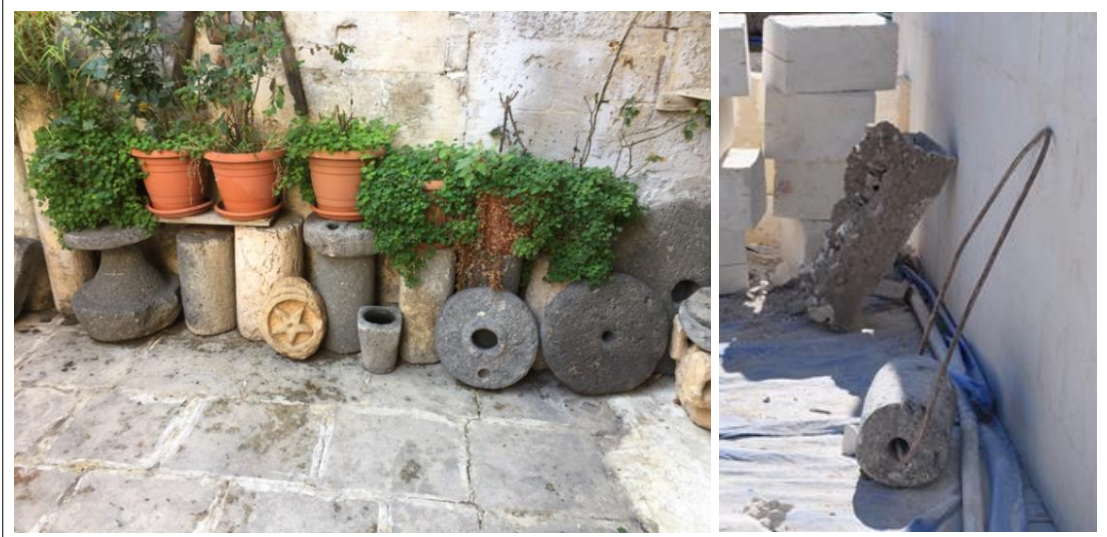
Şekil 5.79. Loğ aleti ve loğ taşları
