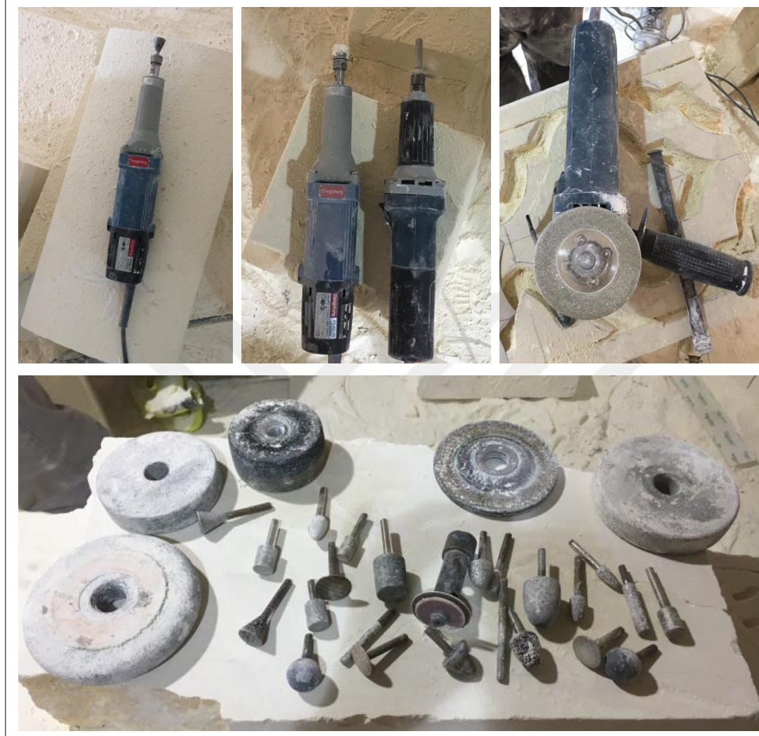
Şekil 6.1. Zımpara makinaları ve kullanılan çeşitli uçları
