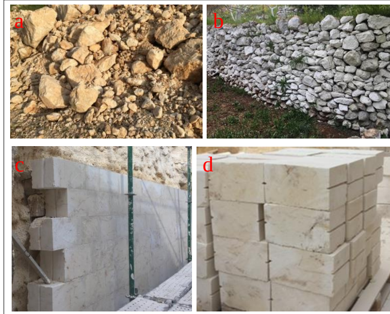
Şekil 4.17. Geleneksel Urfa evlerinde kullanılan kireç taşı çeşitleri a. Moloz Taş b. Kaba Yonu Taş c. İnce Yonu Taş d. Kesme Taş
