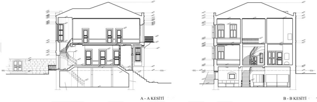
Şekil 4.65 Restorasyondan sonra yapının kesitleri (Ercüment Tekin'in arşivinden)
