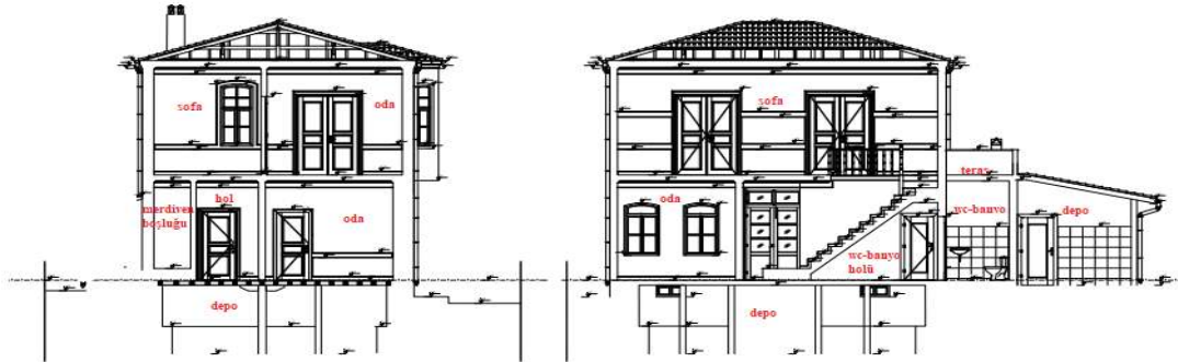
Şekil 4.27 Yapının mevcut durumuna ait bina kesitleri (Ercüment Tekin)
