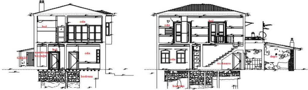
Şekil 4.26 Yapının önceki durumuna ait bina kesitleri (Ercüment Tekin)
