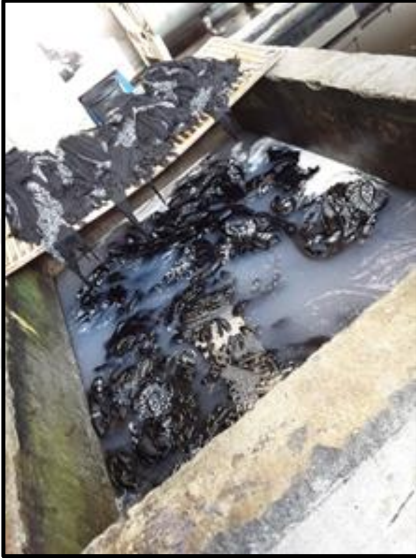
Görsel.78: Tokat 75. Yıl Yazmacılar Hanı, Yumuşatıcı Havuzları (Selek, 07.12.2019)
