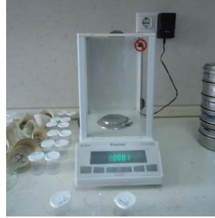
Resim 3.14. Harç ve sıva örneklerinin elekten geçirilip tartılması, 2011 [34]
