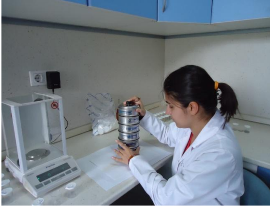
Resim 3.14. Harç ve sıva örneklerinin elekten geçirilip tartılması, 2011 [34]
