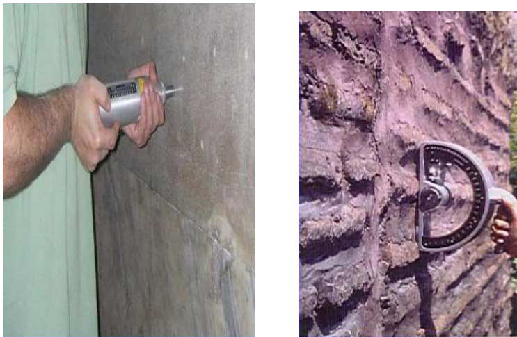
Resim 3.6. N tipi ve P tipi Schmit çekici ile yüzey sertliğinin ölçülmesi [3]
