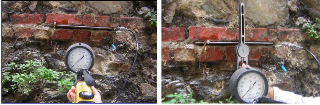
Resim 3.3. Yük altında basınç deneyi [3]
