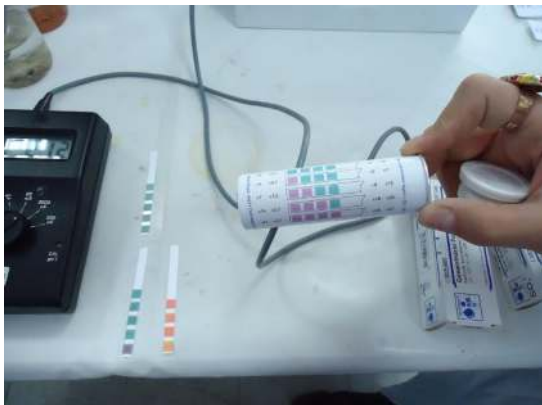
Resim 3.11. Spot tuz testlerinde örneklerin pH tespitlerinin yapılması, 2011 [34]
