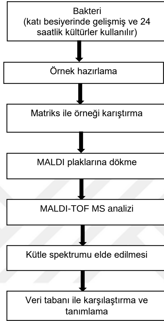
Şekil 3.3. MALDI-TOF MS cihazı ile tanımlama işleminin basamakları [132].
