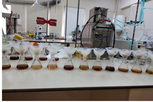
Şekil 2. 16. Şeker analizi çözeltilerin filtre kağıdından geçirilmesi
