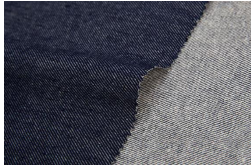
Resim 1- Atkısı indigo boyanmış ve çözgüsü ham iplikle dokunmuş denim kumaş örneği
