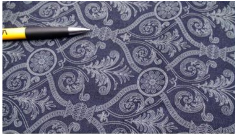
Resim 45-Denim Kumaş üzerine Vav Predator ile yapılmış desen çalışması Kaynak: http://vavtechnology.com/wp-content/uploads/2017/07/laser9.jpg , 2019.
