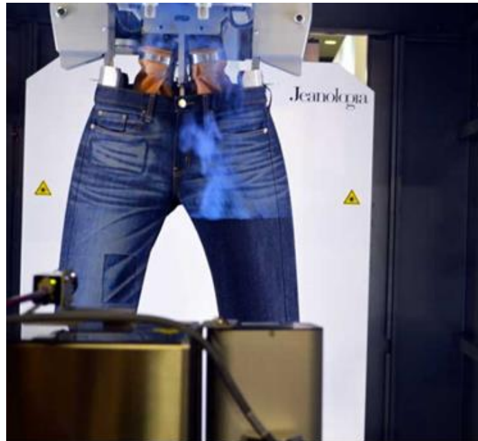
Resim 43- Jenalogia Flexi Pro ile denim pantolona yapılan kuru işlem örneği Kaynak: https://wordpress.textileworld.com/wp-content/uploads/2016/05/Jeanologia.jpg , 2019.
