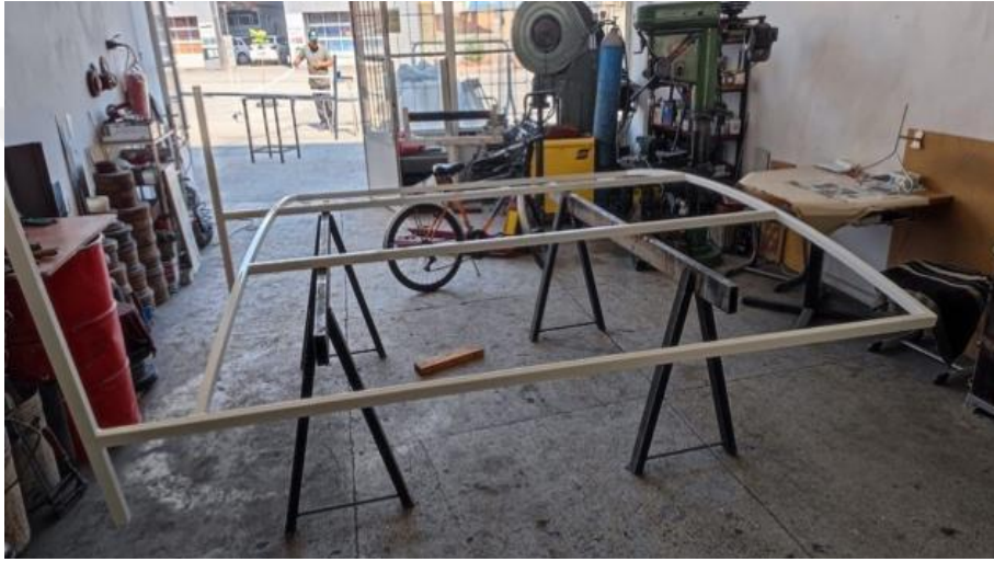
Şekil 13. Projeeksiyon perdesine ait yatay profillerin bükülme işlemi
