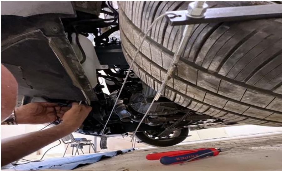
Şekil 25. Ön lastikleri birbirine bağlayan halat montajı
