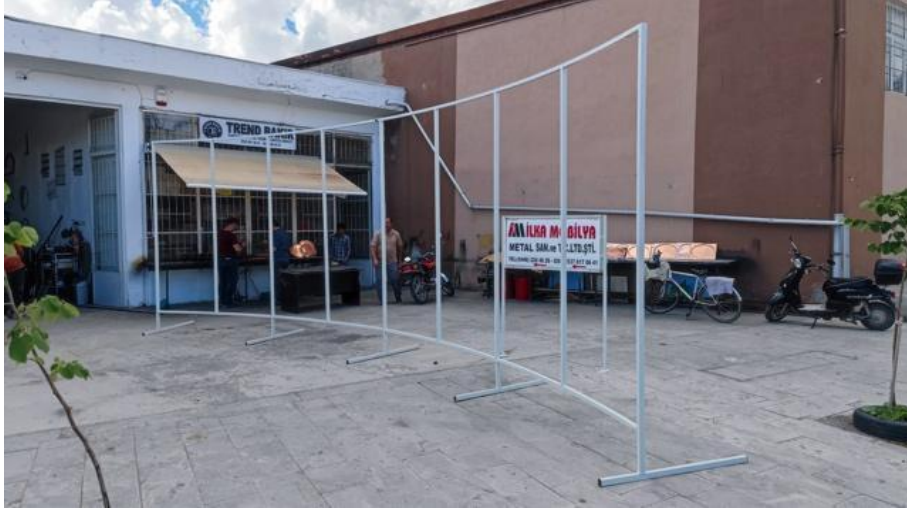
Şekil 15. Projeksiyon perdesi iskeletine uygulanan antipas ve boya işlemleri
