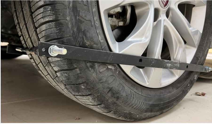
Şekil 24. Ön lastiklerine dört adet metal yönlendirme çubuğunun monte edilmesi
