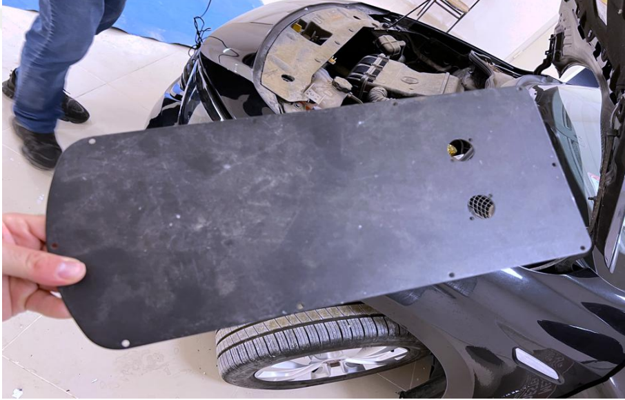
Şekil 28. Makara sisteminin şasiye sabitlenmesini sağlayan özel montaj aparatı
