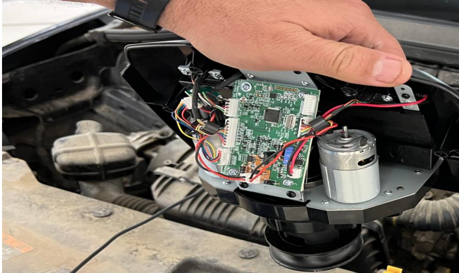
Şekil 26. Çelik halatın hareketlerini algılayan makara sistemi
