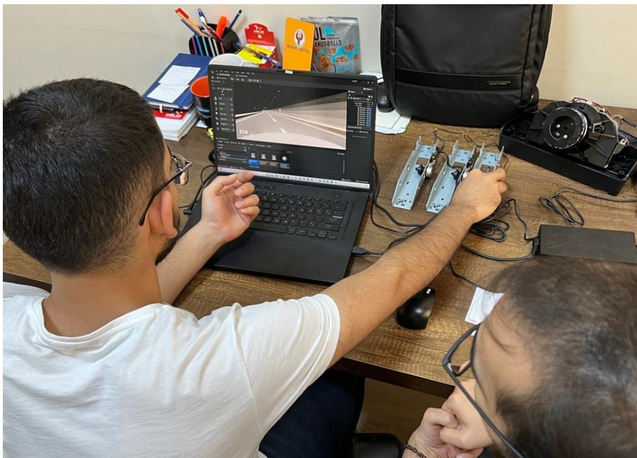
Şekil 21. Simülasyon aracındaki gaz ve fren pedallarına yönelik kalibrasyon işlemleri
