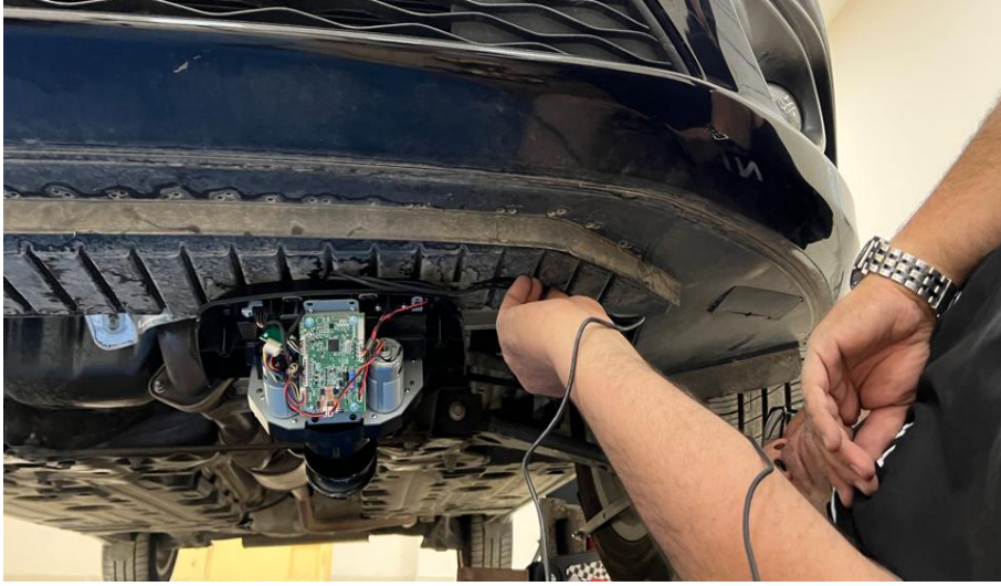
Şekil 27. Halat hareketlerini algılayan makara sisteminin aracın ön bölümüne montajı
