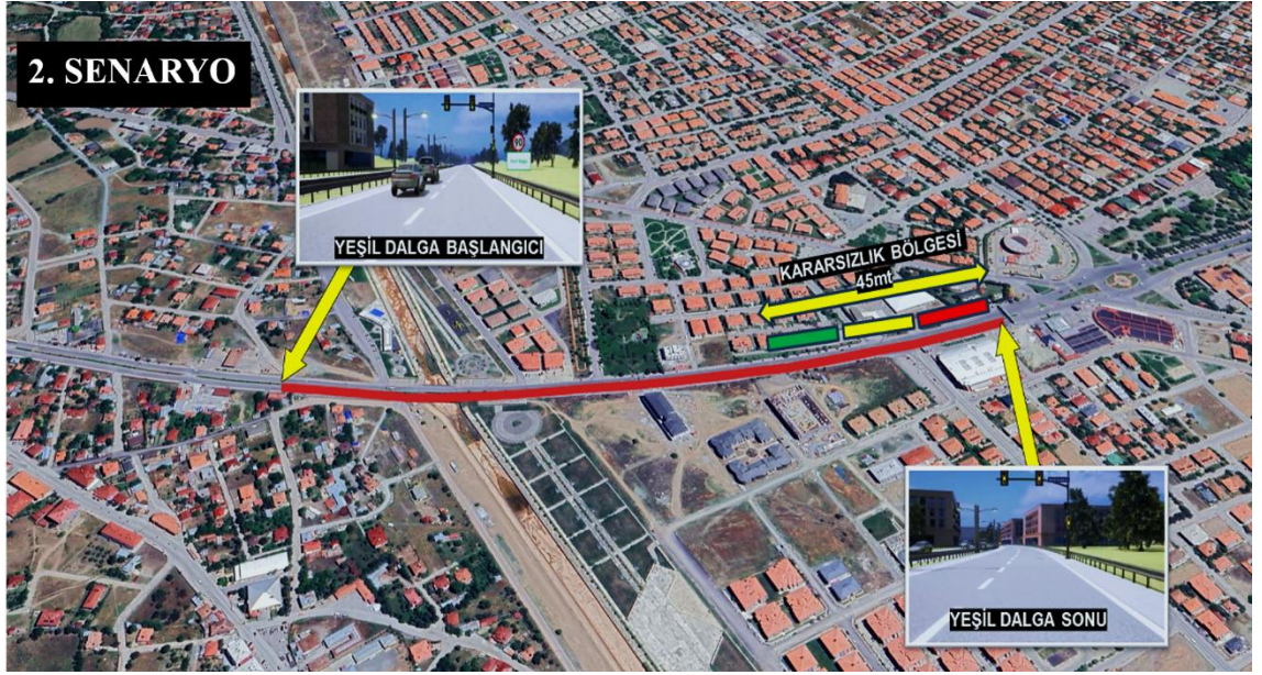
Şekil 36. Yeşil dalga senaryosuna ilişkin şematik kavşak çizimi ve simülasyon ortamından elde edilen ekran görüntüleri
