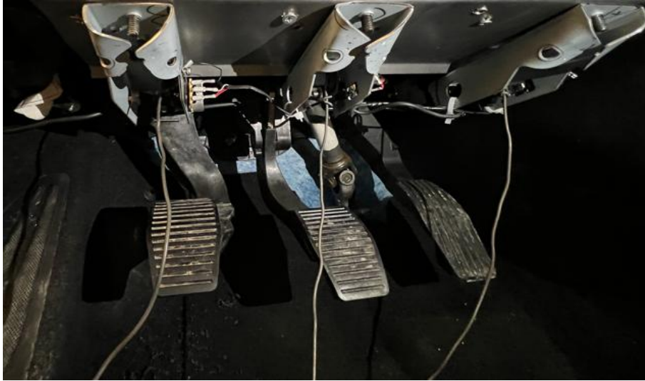
Şekil 23. Dinamometre sistemiyle pedallara uygulanan kuvvetin dijital sinyallere dönüştürülerek simülasyon yazılımına aktarılması süreci
