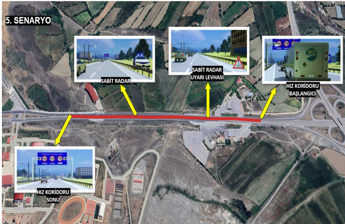
Şekil 40. Hız koridoru senaryosuna ilişkin güzergâhtaki sabit radar, uyarı levhası ve koridor başlangıç/bitiş noktaları
