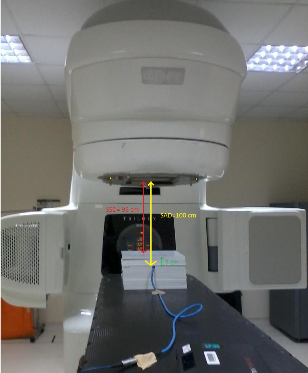
Şekil 3.2.33. Farklı iyon odaları için ölçüm düzeneği.
