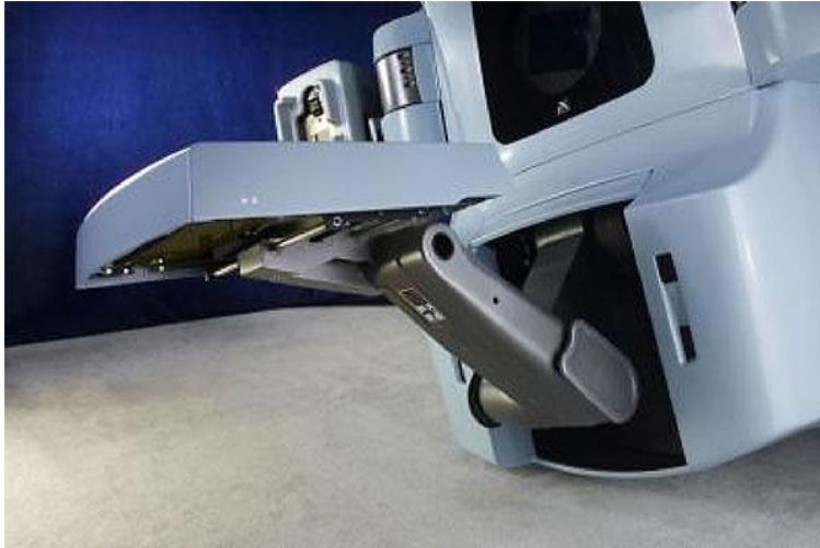
Şekil 3.1.5. Varian Trilogy TX cihazı EPID sistemi.
