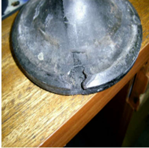
Şekil 5. Yanmaya bağlı egzoz valfi deformasyonu (URL-1, 2025).
