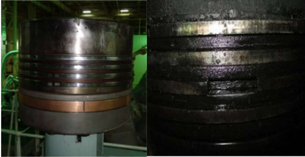
Şekil 6. Piston ve kırık segmanlar (Vukcevic vd., 2019).
