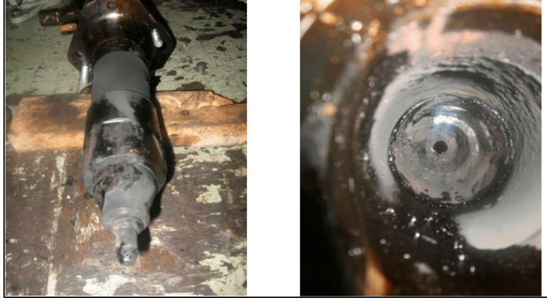
Şekil 3. Enjektör nozul ve yuva kısmındaki deformasyon (Bejger ve Drzewieniecki, 2020).
