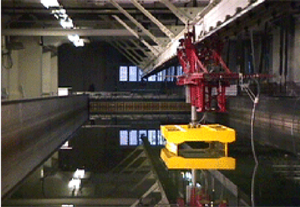
Şekil 1. Çekme tankı deney düzeneği [1]
