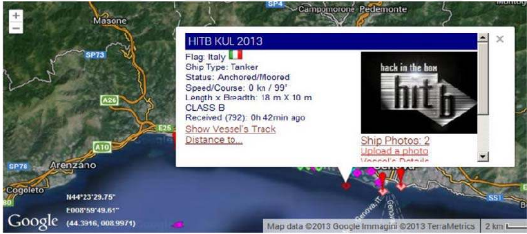
Şekil 19. Var olmayan bir geminin AIS sisteminde oluşturulması (Balduzzi vd., 2014a).
