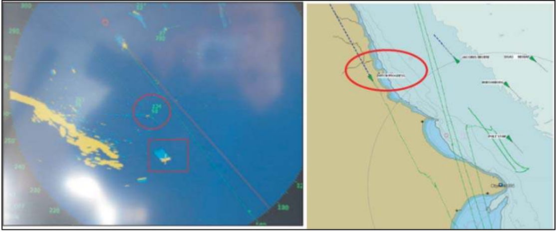
Şekil 13. AIS bilgilerindeki hatalar (Grant vd., 2009).
