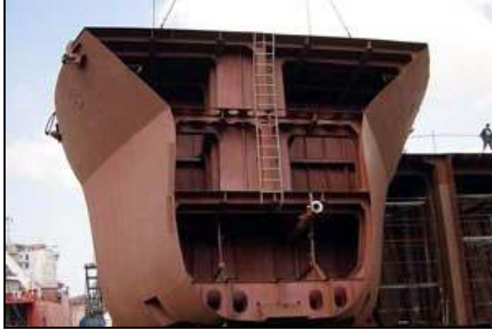
Şekil 6.44 Bloğun kızak eğimine uygun olarak kaldırılması. [15]
