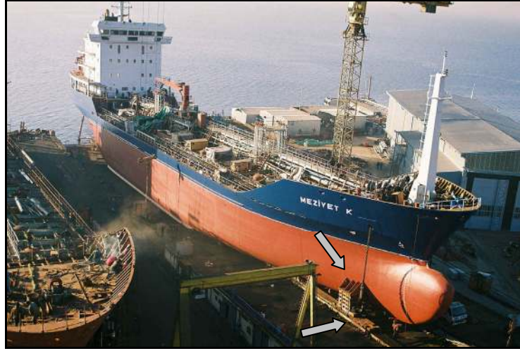
Şekil 7.8 Kızakların ve papetlerin yerleşimleri. [8]
