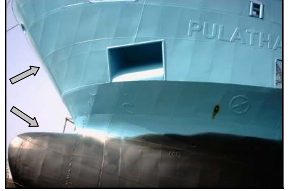
Şekil 6.51 Kat boyalarının uygulanması.
