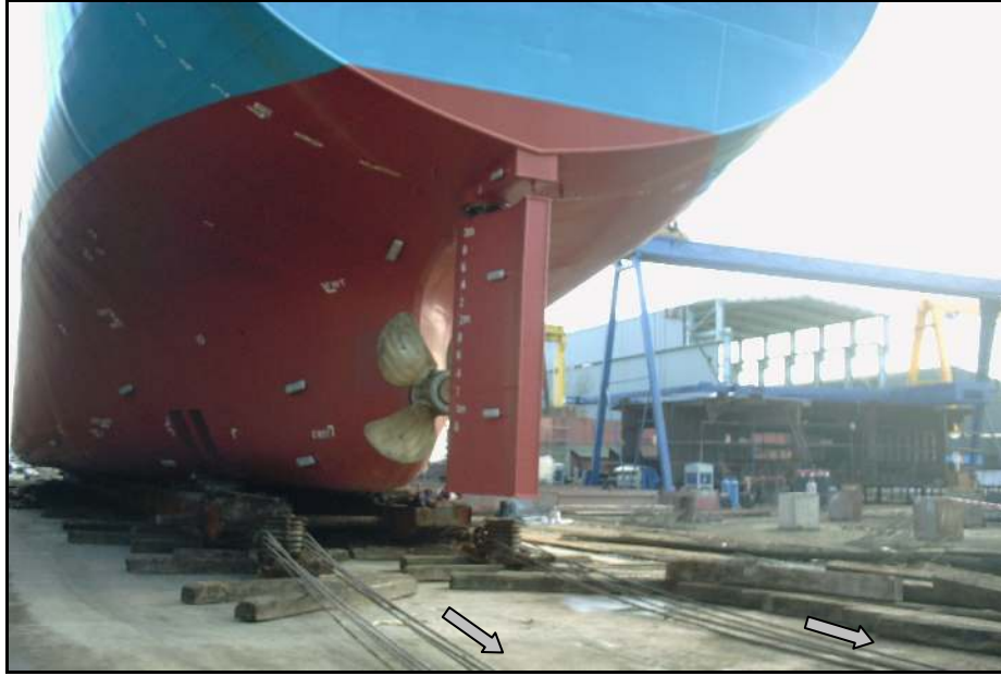
Şekil 7.16 Uygun doğrultu yakalandıktan sonra rıhtıma doğru çekme operasyonu.
