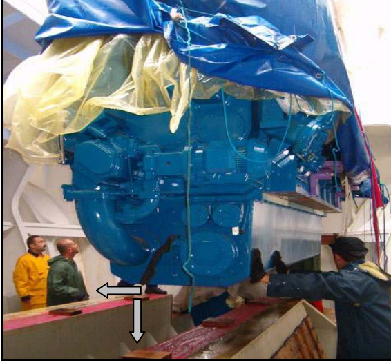
Şekil 6.61 Ana makinenin yerine alınması.
