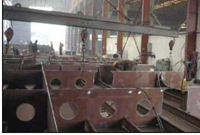
Şekil 6.34 Gruplu panelin imalat aşaması. [15]
