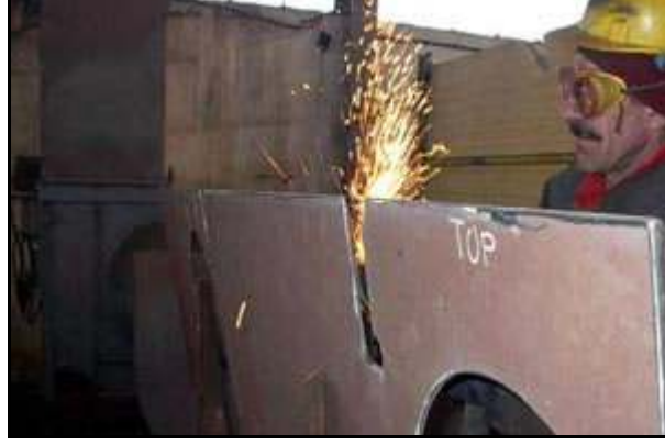
Şekil 6.26 Ön imalat atölyesindeki taşlama işlemi. [15]
