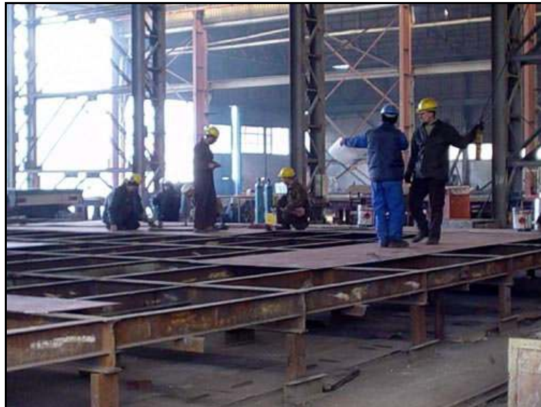
Şekil 6.31 Birleştirilecek olan panel saclarının üretim tezgahına serilmesi. [15]
