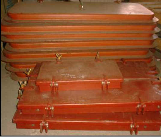
Şekil 6.15 Çelik kapıların depolanması.
