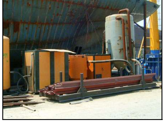
Şekil 6.6 Profil ve köşebent istif sepeti.
