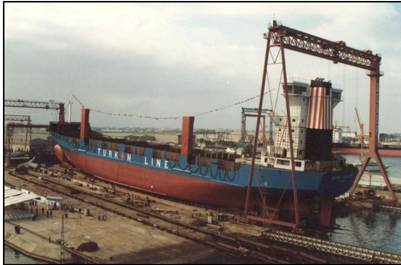
Şekil 7.1 Geminin denize iniş öncesi kızaktaki konumu. [11]
