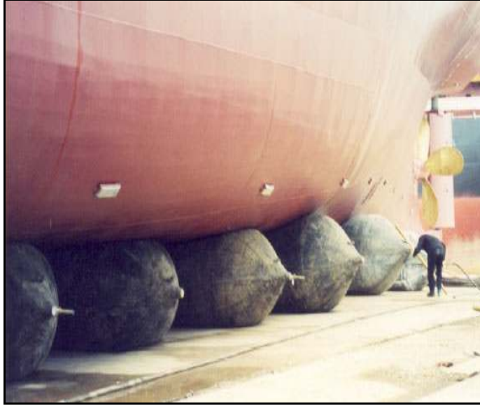
Şekil 7.17 Air-bag kullanımı ile geminin denize indirilmesi.
