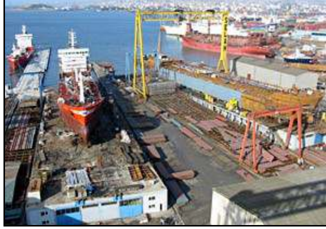
Şekil 6.48 Tersane alanındaki kaldırma ve taşıma altyapısı (açık saha kreyinleri). [12]
