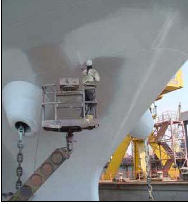
Şekil 6.19 Boyanın kullanılma ve uygulanma aşaması. [4],[5]
