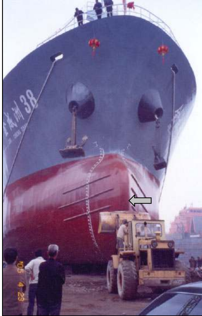
Şekil 7.19 Denize inişte ilk hareketin bir iş makinasıyla verilmesi.
