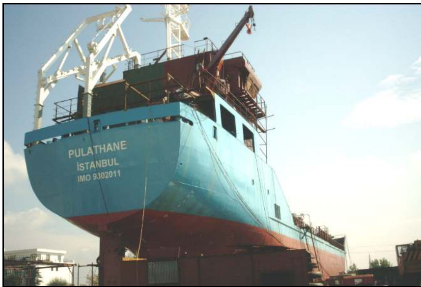
Şekil 4.28 Kumanya ve kurtarma botu kreyini ile serbest düşmeli bot mataforası.
