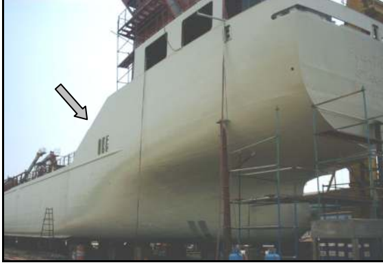
Şekil 6.50 Dış kaplamadaki ilk kat boyası.
