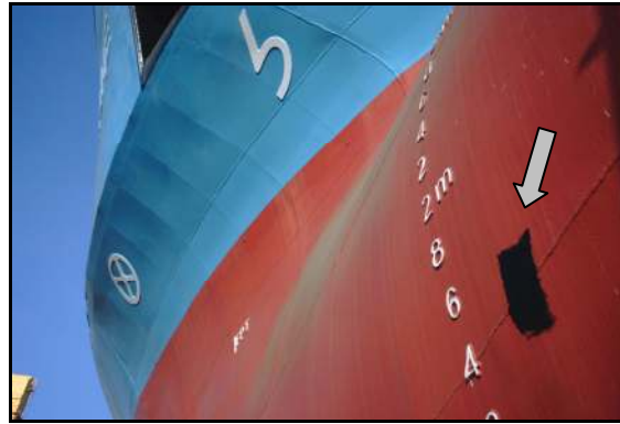
Şekil 6.55 Onarımına başlanmış boya hasarı (touch-up işlemleri).
