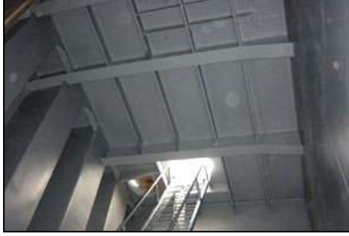
Şekil 6.39 Son kat boyası atılan kargo tankı. [15]
