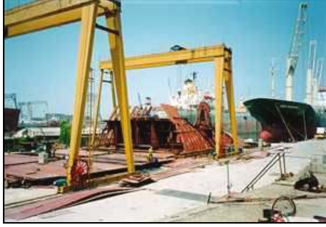
Şekil 6.36 İmal edilecek olan bloğa uygun alan, kreyn ve tezgahın seçilmesi. [12]
