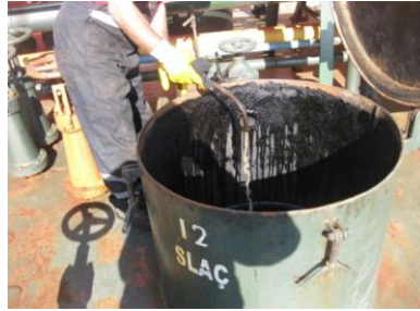
Şekil 4.2 : Atık alım gemisindeki slaç tankı.
