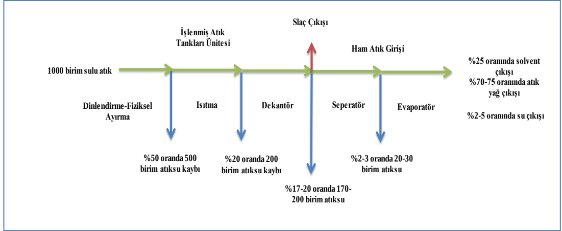
Şekil 5.2 : Proses atıksu kütle dengesi.
